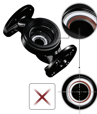
Virheellisesti keskitetty tiivistejärjestelmä
