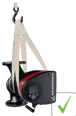
Nostoliinojen oikea kiinnitystapa moottoriosaan ja jäähdytysriivoihin
