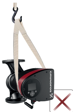
Pumpun väärä nostotapa pumpun ohjauskotelosta
