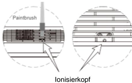
Sollten bei Betrieb knackende Geräusche auftreten, sollten Sie den Kopf (wie auf dem Bild beschrieben) mit einem Pinsel vom Staub befreien.
