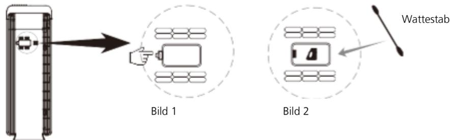
Öffnen Sie hierzu die seitliche Klappe (Bild1) und wischen Sie den Sensor vorsichtig mit einem Wattestab sauber.
