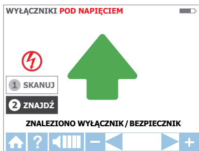
Rysunek 3.3f: Tryb LOKALIZUJ – zidentyfikowany wyłącznik/bezpiecznik
