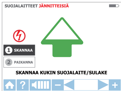
Kuva 3.3c: SKANNAUS-tila – Katkaisijoiden/sulakkeiden skannaus
