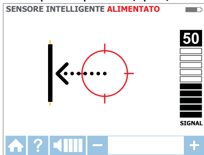
Figura 3.1e: Cavo a sinistra
