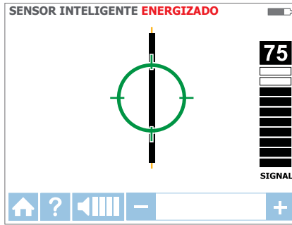
Figura 3.1f: Receptor bloqueado en cable
