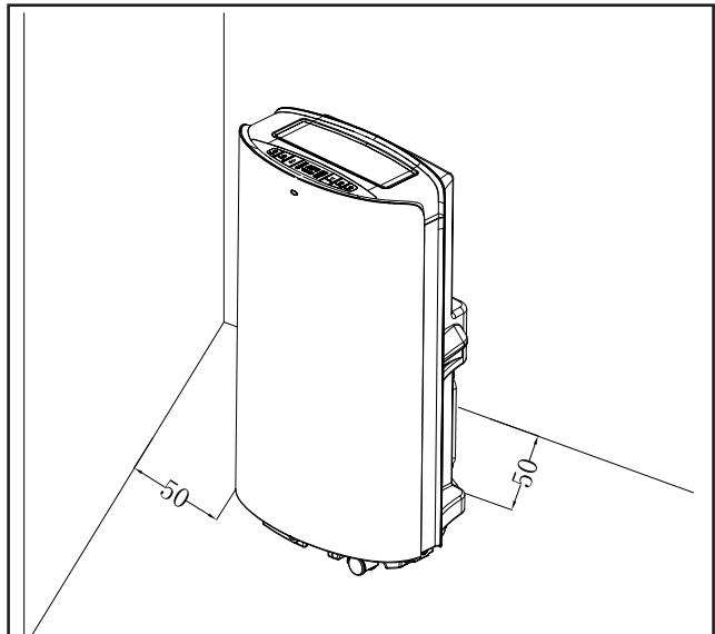
3. Oro kondicionierius, veikiantis tokioje uždaroje erdvėje kaip spinta, bus mažai veiksmingas, jeigu nebus užtikrinamas tinkamas oro srauto patekimasis į erdvę ir išmetimas iš jos. Mobilus oro kondicionierius pašalina šilumą iš prietaiso per ventiliatoriaus žarną ir išmeta per langą arba išmetamojo oro vožtuvą.
