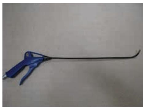
Reinigen Sie mit Druckluft mit passender Düse.
