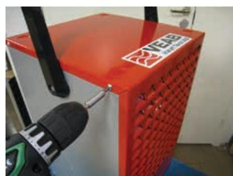
Zur Reinigung entfernen Sie die obere Geräteabdeckung
