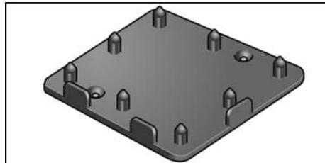
Mit diesem Locher werden acht Löcher im Schleifblatt gestochen. Durch diese Löcher wird der Schleifstaub direkt am Entstehungsort durch die Schleifplatte abgesaugt. Mit 2 Senkschrauben kann der Locher an die Werkbank oder an die Wand montiert werden.
