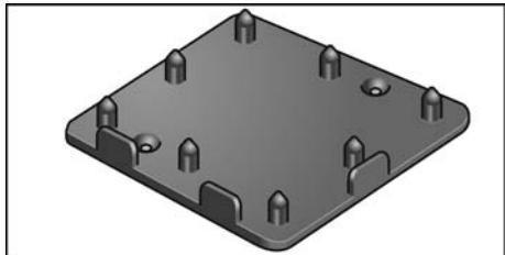
Håslaget används för att göra åtta hål genom sliparket. Dessa hål tillåter slipdammet att sugas ut direkt genom sliparket. Håslaget kan monteras på arbetsbänk eller vägg med hjälp av 2 skruvar.
