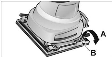
2. Sitúe un extremo de 115 mm de ancho de un pedazo de papel de lija de 115 mm x 140 mm debajo de la abrazadera para papel abierta (1.) y sujetelo mientras sube la palanca de dicha abrazadera y la coloca detrás de la lengüeta de fijación para sujetar el papel en su sitio (2.).
