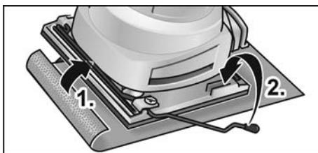
3. Den zweiten Klemmbügel öffnen (wie im 1. Schritt beschrieben wird).
