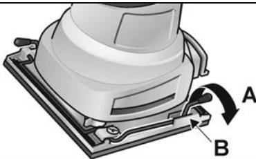
2. Posizionare una estremità larga da 115 mm, di un foglio di carta vetrata da 115 mm x 140 mm, sotto il morsetto aperto della carta (1.) e tenere fermo mentre al tempo stesso si soleva la leva del morsetto della carta e si sistema la carta dietro la linguetta di bloccaggio per fissare a posto la carta (2.).
