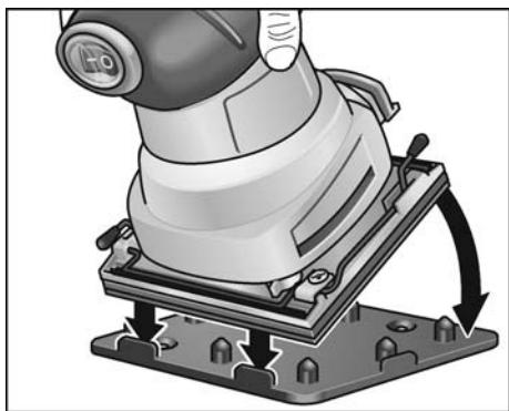
3. Tag bort slipmaskinen från hålslagen.
