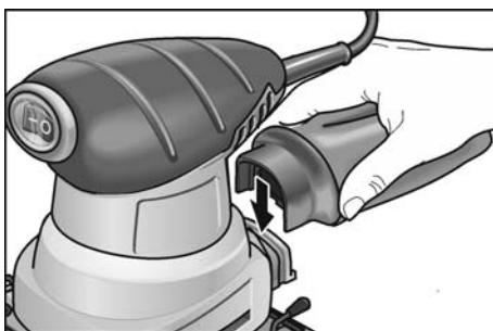
2. Periodicamente rimuovere il contenitore della polvere dalla flangia e svuotare la polvere raccolta.
