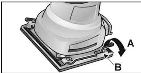
2. Das schmalere (115 mm) Ende eines 115 mm x 140 mm Schleifblattes unter den offenen Klemmbügel legen (1.) und festhalten, während der Hebel des Klemmbügels angehoben wird und der Klemmbügel in die Spannposition der Halteklammer zurückgeschoben wird, um das Schleifblatt zu befestigen (2.).
