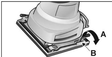
2. Steek het eind van een stuk schuurpapier van 115 mm breed, van een 115 mm x 140 mm stuk schuur papier onder de open papierklem (1.), en houd het op zijn plaats, terwijl de hefboom van de papierklem wordt opgetild en het schuurmiddel achter het uilsteeksel voor het vastzetten van het papier wordt geplaatst, om het op zijn plaats vast te zetten (2.).
