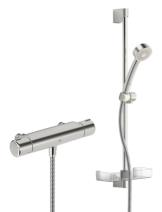
Termostatblandare för dusch. Temperaturvred med säkerhetsspärr vid 38°C, volymvred med kontroll för Ecoflöde, keramisk överdel. Blandaren är utrustad med backventiler och smutsfilter. Oras Apollo duschset består av handdusch, duschstång 650 mm, tvålkopp och duschslang 1500 mm.
