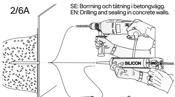
DK: Boring og forsegling i betonvägg., NO: Boring og tetting i betongvegger,
