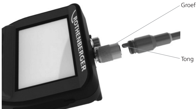
Afbeelding 6 - Kabelaansluitingen (connector type „A“, zwarte 9-pin connector)
