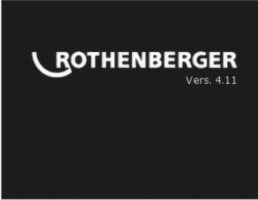
Kuva 12 – Käynnistäminen/Aloitusnäyttö – Osoittaa käsikäyttöisen yksikön nykyisen laiteohjelmistoversion
