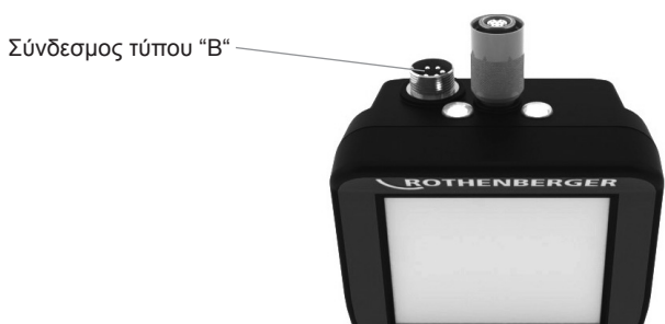
Εικόνα 7 - Συνδέσεις καλωδίου (σύνδεσμος τύπου “Β”, ασημί σύνδεσμος 5 ακίδων) (Ο σύνδεσμος τύπου “Β” χρησιμοποιείται για τη σύνδεση προηγούμενων εκδόσεων του καλωδίου μονάδας απεικόνισης ROSCOPE στη συσκευή ROSCOPE i2000)
