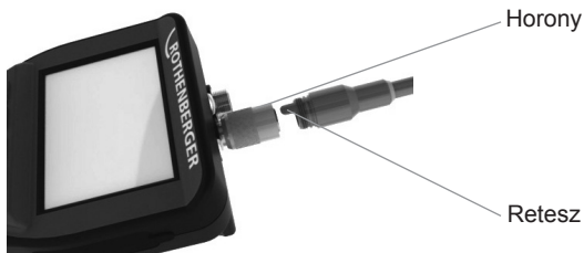
6. Ábra - Kábel csatlakoztatások (Csatlakozó típusa: "A", fekete 9-Pin típ. csatlakozó)
