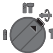
Poziție Vario-Lock pentru reglarea poziției dălții În această poziție comutatorul stop percuție/stop rotație 13 nu se înclichetează.
