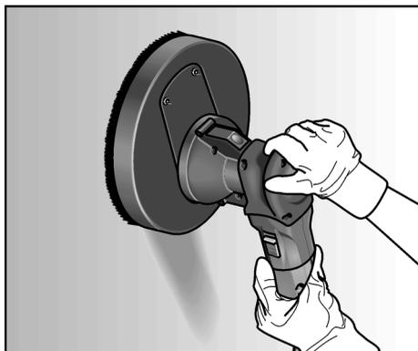
7. Шлифовальную машину для стен следует держать всегда за обе рукоятки. Шлифовальную машину для стен прижмите слегка к рабочей поверхности (нажатие должно быть достаточным для того, чтобы шлифовальная головка плотно прилегалась к рабочей поверхности).
