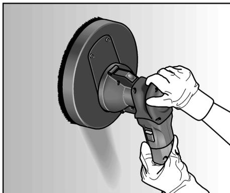
7. Uchopte brúsku na steny za obe rukoväte. Tlačte brúsku na steny ľahko proti pracovnej ploche (prítlak by mal byť dostatočne silný, aby sa zaručilo, že brúsna hlava leží v jednej rovine s pracovnou plochou).
