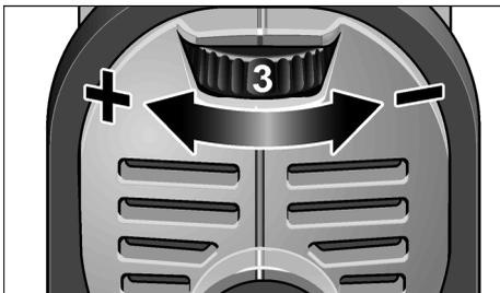
K nastavení pracovních otáček nastavte nastavovací kolečko na požadovanou hodnotu. Otáčky jsou nastavitelné od 600–1800 min<sup>-1</sup>.
