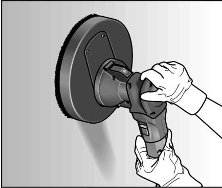
7. De wandschuurmachine aan de beide handgrepen vastpakken. De wandschuurmachine licht tegen het werkkoppervlak drukken (de druk moet juist sterk genoeg zijn om ervoor te zorgen dat de schuurkop vlak op het werkkoppervlak aansluit).
