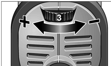
Na nastavenie pracovných otáčok nastavte nastavovacie koliesko na požadovanú hodnotu.
