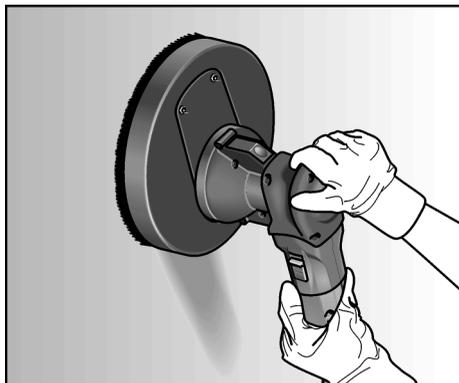
7. Afferrare la levigatrice per pareti e soffitti su entrambe le maniglie. Premere leggermente la levigatrice per pareti e soffitti sulla superficie di lavoro (la pressione deve essere appena sufficiente per garantire che la testa levigatrice vada in piano sulla superficie da lavorare).
