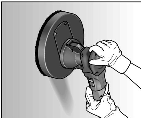
7. Vegg slipemaskinen holdes fast i de to håndtakene. Vegg slipemaskinen trykkes lett mot arbeidsflaten (trykket bør være stort nok for å garantere at slipehodet er i plan med arbeidsflaten).
