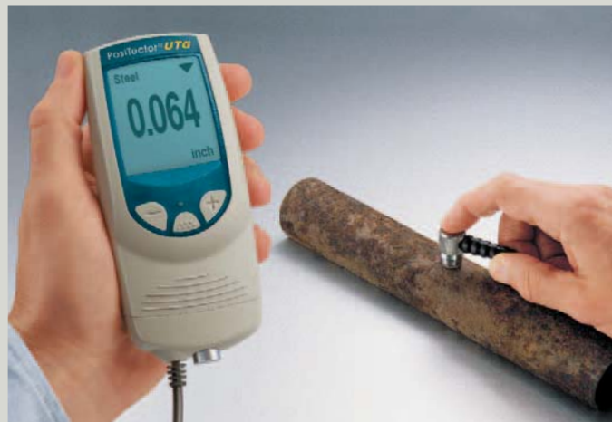
UTG Std mäter tjockleken på rör, tankar, skrov mm. snabbt och enkelt, även vid korrosion
