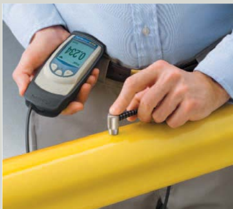
Display med möjlighet till att justera textorienteringen åt det hållet du håller mätaren.
