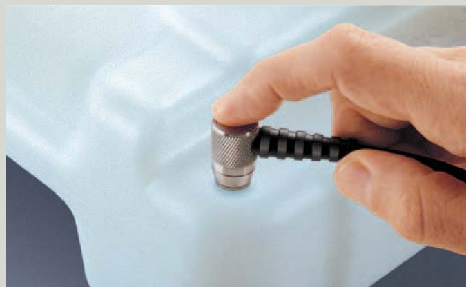
Mätning av tjockleken på en plastbehållare
