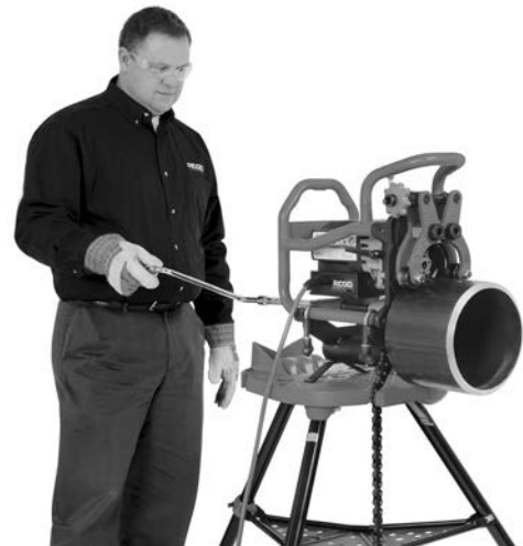
Figure 20C – Biseautage en cours (machine fixe/tuyau mobile)
