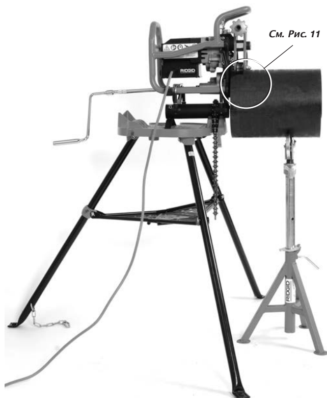
Рис. 12 – Закрепленный станок для снятия фаски, длина трубы меньше 12” и вес меньше 50 фунтов
