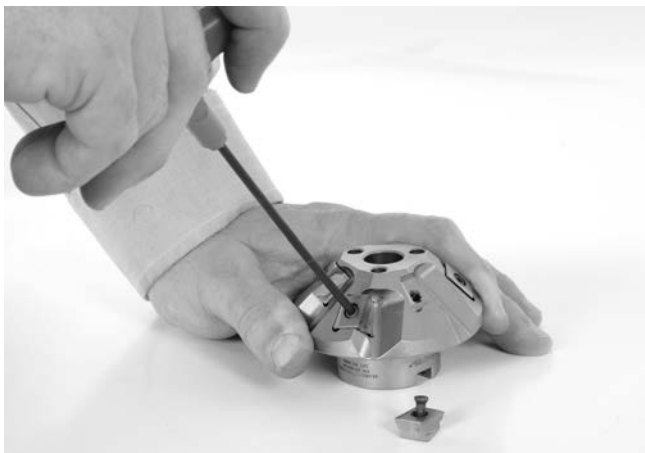
Figure 24 – Remplacement des couteaux
