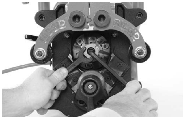
Рис. 25А – Замена режущих головок
