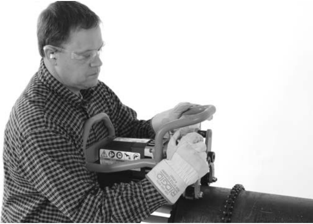
Şekil 17A – Sıkıřtırma Vidasını Elle Sıkın
