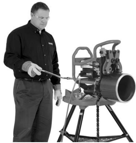
Figura 20C – Operación de biselado (biseladora fija/tubo en rotación)
