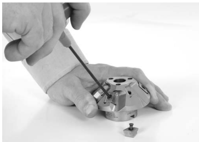
Рис. 24 – Замена вставных резцов
