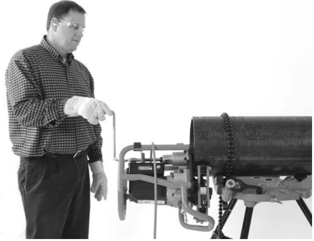
Şekil 20B – Pahlama İşlemi (Sabit İş Parçası/Hareketli Pahlama Makinesi)
