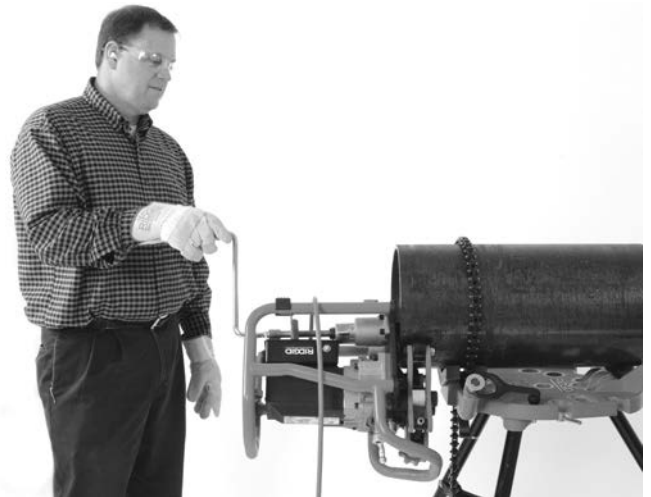
Figura 20B – Operación de biselado (pieza fija/biseladora móvil)
