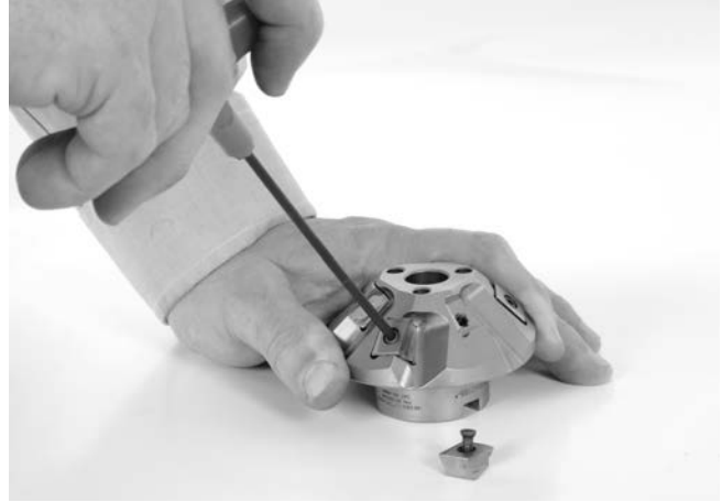
Şekil 24 – Kesici Bagaların Değiştirilmesi
