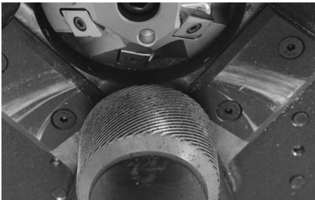
Рис. 22 – Чистые насечки ведущего ролика
