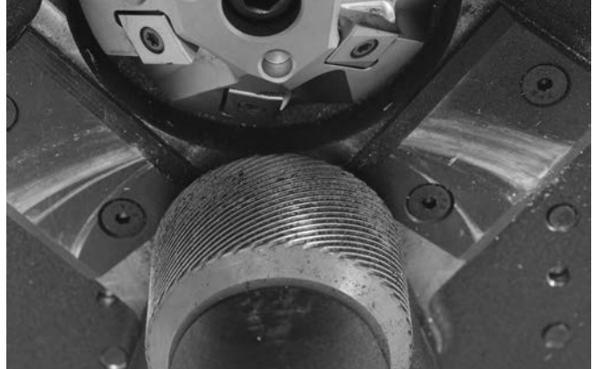
Figure 22 – Nettoyage du moletage du galet d'entraînement
