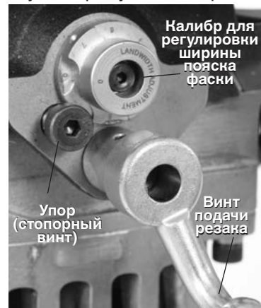
Рис. 18 – Установка калибра для регулировки ширины пояска фаски
