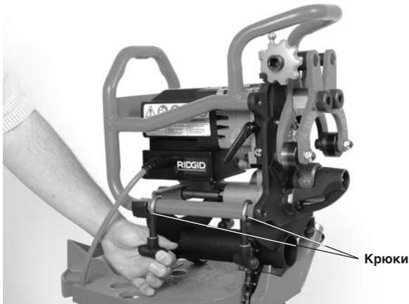
Рис. 9 – Крепление станка для снятия фаски к держателю
