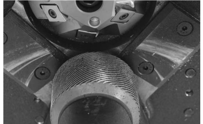
Şekil 22 – Tahrik Silindiri Dişlisini Temizleme
