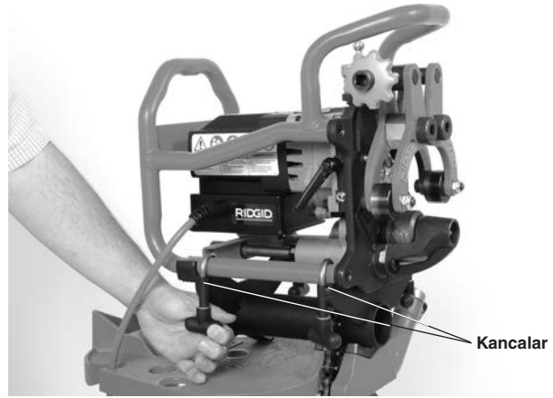
Şekil 9 – Pahlama Makinesinin Adaptöre Tespit Edilmesi
