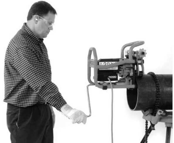
Şekil 19 – Düzgün Çalıřtırma Konumu
