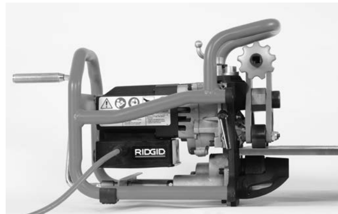
Şekil 16B – Pim Plakası Kilit Vidası Pahlama Makinesinin Plakanın Üzerinde Kurulması
