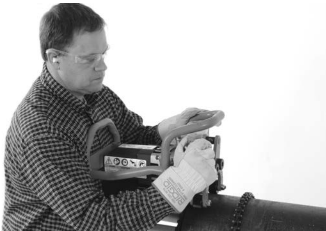
Figure 17A – Serrer la vis de blocage manuellement
