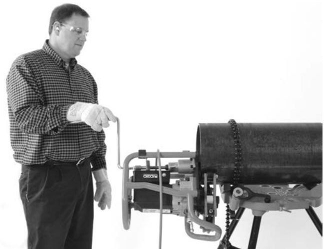
Figure 20B – Biseautage en cours (pièce fixe/machine mobile)
