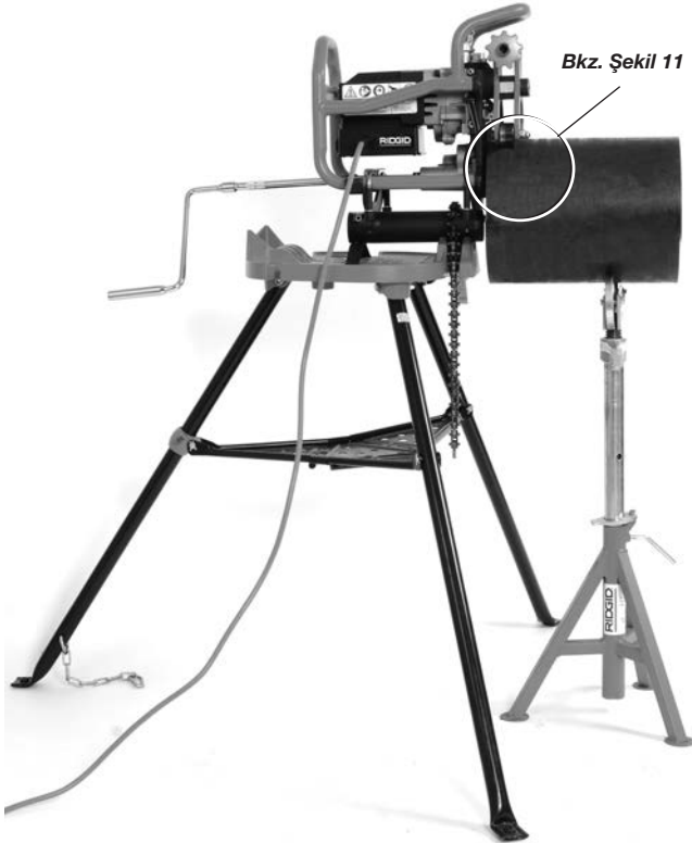
Şekil 12 – Sabit Pahlama Makinesi, Kısa Boru, Bir Boru Standı
