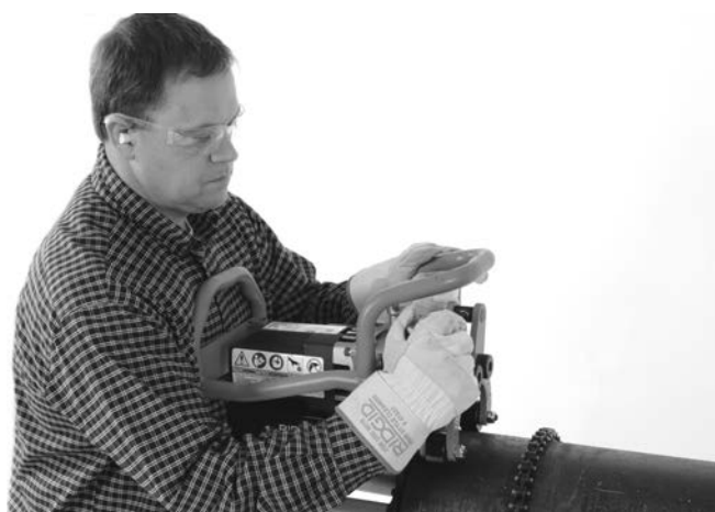
Рис. 17А – Затягивание зажимного винта от руки
