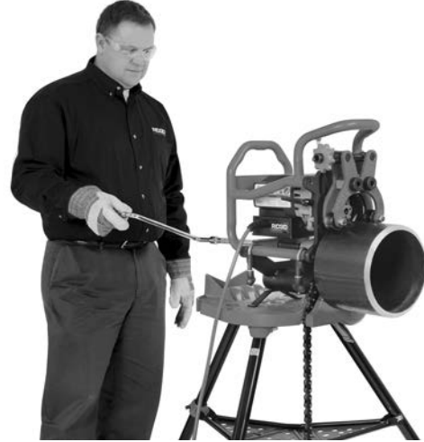
Şekil 20C – Pahlama İşlemi (Sabit Pahlama Makinesi/Dönen Boru)
