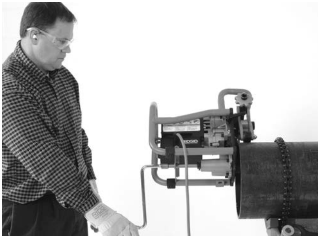
Figure 20A – Biseautage en cours (pièce fixe/machine mobile)
