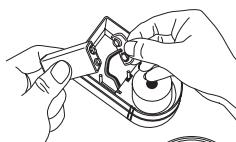
Placera batteriet enligt illustrationen till höger. Korrekt placering av batteriet gör att enheten kan flyta vid till exempel översvämnning. Stäng höljet noggrant.
