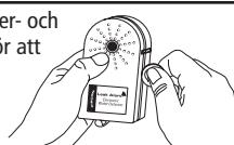
Vid låg batterinivå kommer fuktvarnaren att pipa (kort pip var 5:e sekund). Byt ut 9-volts batteriet till ett nytt omgående (helst alkaliskt).
