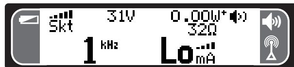
Figur 24. Displayen indikerar att strömstyrka är låg
