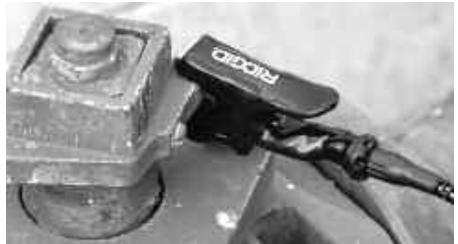
Figur 8. Ansluta kabelledningen till målledaren
