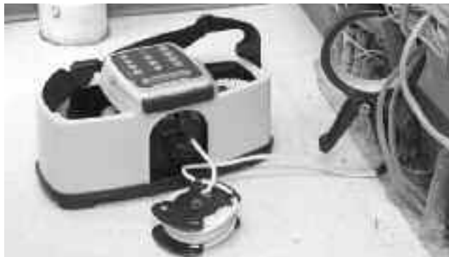
Figur 12. Den induktiva klämman ansluten till en ledare
