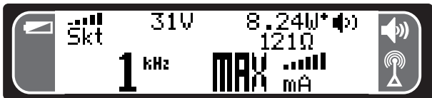
Figur 23. Displayen visar maximal strömstyrka
