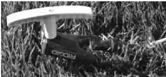
Figur 7. Ansluta ledningen till jordspettet
