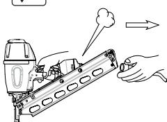
Do łączenia z systemem sprężonego powietrza należy używać tylko szybkozłączek, tak aby po rozłączeniu nie pozostało w narzędziu sprężone powietrze.
