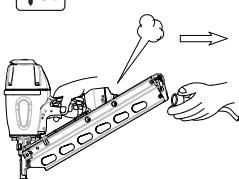
Vid tryckluftanslutning ska snabbkopplingar användas. Nippeln måste ha fritt genomflöde och sörja för att ingen tryckluft finns kvar i verktyget efter att luftslangen fränkopplats.
