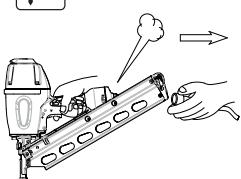
Snelkoppelingen moeten worden gebruikt voor aansluiting op het persluchtsysteem en de niet-afslutbare nippel moet op zodanige wijze op het gereedschap worden aangebracht dat na ontkoppeling geen perslucht in het gereedschap achterblijft.
