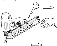
Paineilmajärjestelmään liittäminen on tehtävä pikaliittimillä, ja työkaluun on kiinnitetvävä tiivistämätön nippa siten, ettei paineistettua ilmaa jää työkaluun sen jälkeen kun liitos avataan.
