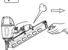
Utilizzare gli attacchi rapidi per la connessione dell'aria compressa per evitare che residui di aria compressa rimangano all'interno dell'utensile in sede di scollegamento.
