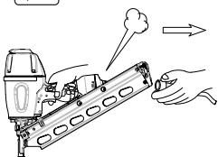
Für den Anschluss an das Druckluftsystem sind Schnellkupplungen zu verwenden; der unverschließbare Nippel muss so am Werkzeug befestigt sein, dass nach Trennen von der Druckluftversorgung keine Druckluft im Gerät verbleibt.
