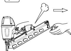
Sıkıştırılmış hava sistemiyle bağlantı için sıkıştırılmış hava bağlantısı kesildikten sonra alette hava kalmamasını sağlayacak hızlı hareketli kaplınlar kullanılmalıdır.
