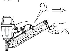
Se usarán acoplamientos de cierre rápido para la conexión al sistema de aire comprimido de modo que no queden restos de aire comprimido en la herramienta después de desconectarla.
