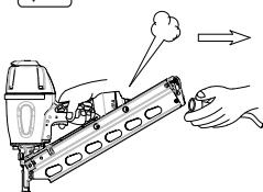
Des raccords rapides doivent être utilisés pour le raccordement au réseau d'air comprimé et l'embout mâle non étanche doit être monté côté machine afin qu'il ne reste pas d'air comprimé dans la machine après déconnexion.
