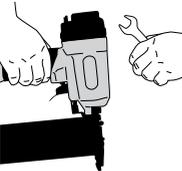
A karbantartás, elakadt rögzítő kivétele, a munkaterület elhagyása, a szerszám másik helyre történő áthelyezése vagy a szerszám másik ember által történő használata előtt válassza le a szerszámot a levegőforrásról. Soha ne használja a szerszámot, ha a biztonsági rögzítő, a ravasz vagy a rugók hiányoznak vagy megsérülnek. Soha ne babrálja vagy távolítsa el a biztonsági rögzítőt, a ravaszt vagy a rugókat.
