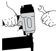
Pred údržbou, uvoľňovaním zaseknutého spojovacieho materiálu, predtým než odchádzate z pracoviska, keď prenášate nástroj na iné pracovisko, alebo keď d podávate nástroj inej osobe, vždy odpojte prívod stlačeného vzduchu. Nikdy nepoužívajte nástroj ak nefungujú, chýbajú, alebo sú poškodené bezpečnostný popruh, spúšť, alebo pružiny. Nemanipulujte ani nedemontujte bezpečnostný popruh, spúšť ani pružiny.
