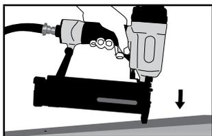
Orodje naj bo usmerjeno stran od vas in drugih. Priključite orodje na dovod zraka. Orodje uporabljajte pri najnižjem tlaku, ki je potreben za uporabo. Tako boste zmanjšali raven hrupa, obrabo delov in porabo energije. Konico orodja potisnite na obdelovanec, ki ga želite pritrditi in pritisnite sprožilec, da izstopijo sponke. Dodajte zgolj minimalni tlak, ki je potreben za prodiranje sponk. Nato naredite nekaj preizkusov, pri čemer začnite pri najnižjem tlaku.
