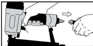
Odklopite orodje od dovoda zraka.
