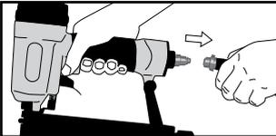
Trennen Sie das Werkzeug von der Druckluftversorgung ab.
