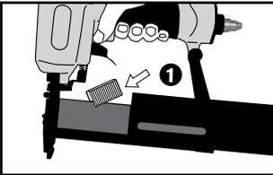
1. Chargement en agrafes : mettre une bande d'agrafes à cheval sur le rail. Repousser le rail jusqu'à encliquetage.
