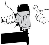
Prije izvođenja postupaka održavanja, uklanjanja prepreke prilikom blokiranog sustava za zabijanje, napuštanja područja rada, prenošenja uređaja na drugu lokaciju ili predavanja uređaja drugoj osobi, uvijek odvojite uređaj od dovoda zraka. Uređaj ne koristite ako se sigurnosni obruč, okidač ili opruge pokvare, oštete ili nedostaju. Ne dirajte i ne uklanjajte sigurnosni obruč, okidač ili opruge.
