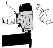
Před zahájením údržby, uvolňováním zaseknutého upínacího prvku, odchodu z pracovní oblasti, přesouváním nástroje do jiného umístění nebo předáním nástroje jiné osobě odpojte nástroj od přívodu vzduchu.
