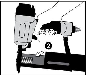
2. Laden von Drahtstiften: Halten Sie die Nagelpistole nach unten und laden Sie einen Streifen Nägel in die Kartusche, wobei die Spitzen nach unten weisen. Drücken Sie auf die Schiene, bis sie mit einem Klicken einrastet. Verwenden Sie nur empfohlene Befestigungselemente (siehe technische Daten).
