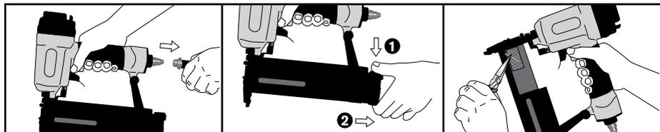
**ОБСЛУЖИВАНИЕ:** Пока инструмент отсоединен от системы подачи воздуха, производите ежедневный осмотр на предмет свободного движения предохранительного держателя и спусковой кнопки.
