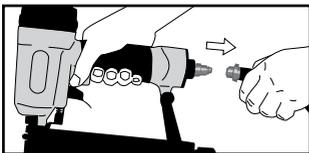
Uređaj odvojite od dovoda zraka.
