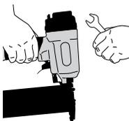
Разкачете инструмента от въздуха преди да извършите поддръжка, почистване от заседнали крепежни елементи, напускане на работното място, преместване на инструмента или предаване то му на друго лице.
