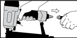
Débrancher l'outil de l'arrivée d'air comprimé.
