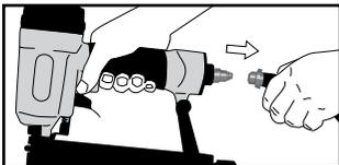
Odłączyć urządzenie od zasilania sprężonym powietrzem.
