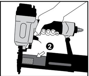
2. Laden van brads: Houd het nietpistool omlaag en laad een strip nieten in de cassette, met de punten omlaag gericht. Druk op de rail totdat deze op zijn plek klikt. Gebruik uitsluitend de aanbevolen nagels (zie de technische specificaties).
