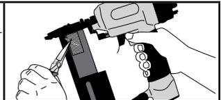
**UNDERHÅLL:** Undersök dagligen att avtryckaren och säkerhetsrelät kan röras fritt. Verktyget ska under tiden vara bortkopplat från tryckluften.
