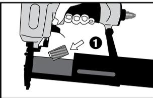
1. Laden von Klammern: Einen Streifen Klammern über die Schiene legen. Drücken Sie auf die Schiene, bis sie mit einem Klicken einrastet.
