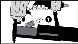
1. Sinkilöiden lisääminen: Aseta sinkiläriivi kiskon päälle. Työnnä kiskoa, kunnes se napsahtaa paikalleen.
