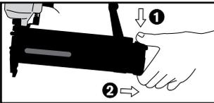
Appuyer sur le bouton à l'arrière du chargeur.
