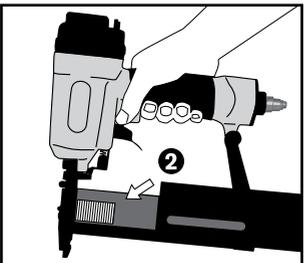
2. Chargement en pointes : Tout en maintenant le cloueur dirigé vers le bas, mettre une bande de pointes dans le chargeur en mettant la pointe des clous contre le bas du chargeur. Repousser le rail jusqu'à encliquetage.
