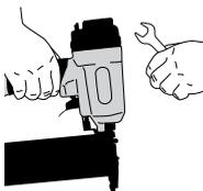
Отсоедините инструмент от системы подачи воздуха перед обслуживанием, извлечением застрявшей снабды, оставлением рабочей зоны, переносом инструмента в другое место или передачей другому лицу. Никогда не используйте инструмент, если предохранительный держатель, спусковая кнопка или пружины неисправны, отсутствуют или повреждены. Не пытайтесь вносить изменения в конструкцию или удалять предохранительный держатель, пусковую кнопку или пружины.
