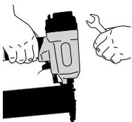
Atvienojiet instrumentu no gaisa, pirms veicat instrumenta apkopi, iesprūdušas saspraudes izņemšanu, atstājot darba zonu, pārvietojot instrumentu uz citu vietu vai nododot to citai personai. Nekad nelietojiet instrumentu, ja drošības sastiprinājums, mēlīte vai atspere ir nelietojami, pazuduši vai bojāti. Nepārveidojiet un nenonēmiat drošības sastiprinājumu, mēlīti vai atspere.
