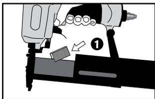
1. Carregamento de agrafos: Coloque uma caixa sobre a calha.
