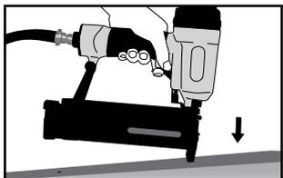
Nástrojem nemířte na sebe ani na ostatní a připojte jej k přívodu vzduchu. Nástroje je nutné používat při nejnižším tlaku potřebném pro dané použití. Snižte tak hladinu hluku, opotřebení dílů a spotřebu energie. Přitlačte špičku nástroje na obráběný díl, který chcete připevnit, a stisknutím spouště vystřelíte skoby. Upravte minimální tlak, který je potřebný k proniknutí upínacích prvků. Poté proveďte několik zkoušek. Začněte s nejnižším tlakem.
