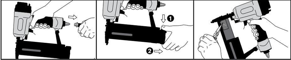
**MANTENIMIENTO:** Mientras la herramienta está desconectada del suministro de aire, haga una inspección diaria para asegurarse del libre movimiento del yugo de seguridad y del disparador. Todos los tornillos se deben mantener apretados. Los tornillos sueltos dan como resultado un funcionamiento inseguro y la rotura de las piezas.
