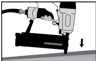
Uređaj ne okrećite prema sebi ili drugima i spojite ga na dovod zraka. Uređaj će se koristiti pod najmanjim tlakom potrebnim za željenu radnju. To će smanjiti razinu buke, habanje dijelova i upora-
