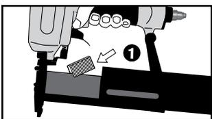
1. Caricamento delle graffe: Sistemare una stecca sulla guida. Premere la guida finché non scatta in posizione. 2. Caricamento dei chiodini: Con la chiodatrice rivolta verso il basso, inserire nella cartuccia una stecca di chiodini con le punte rivolte verso il basso. Premere la guida finché non scatta in posizione. Utilizzare esclusivamente i fermi raccomandati (vedere i dati tecnici).
