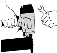
Desconecte del aire la herramienta antes de hacer el mantenimiento de la misma, liberar una fijación atascada, dejar el área de trabajo, desplazar la herramienta a otra ubicación, o traspasarla a otra persona. Nunca use la herramienta si los muelles, el disparador o el yugo de seguridad no funcionan, faltan o están dañados. No manipule ni quite el yugo de seguridad, el disparador ni los muelles.
