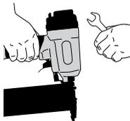
Couper l'arrivée d'air avant toute intervention sur l'appareil (maintenance ou dégagement d'un projectile coincé.) ou avant de vous éloigner du secteur de travail ou avant de déplacer l'appareil, ou encore avant de le donner à une autre personne. Ne jamais utiliser l'outil si le dispositif de sécurité, la détente ou les ressorts ne sont pas opérationnels, ou sont manquants ou endommagés. Ne pas les altérer, ne pas les enlever.
