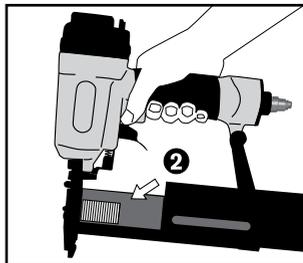
Používajte len odporúčaný spojovací materiál (pozri technické špecifikácie).
