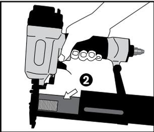
2. Carga de clavillos: Mantenga la pistola de clavillos hacia abajo y cargue una banda de clavillos en el cartucho con las puntas orientadas hacia abajo. Presione el riel hasta que haga clic al encajar en su lugar.
