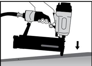
Houd het gereedschap van uzelf en anderen af en sluit het aan op de luchttoevoer. Gebruik gereedschap bij de voor de betreffende toepassing laagst mogelijke druk. Dat zorgt voor een lager geluidsniveau, minder slijtage en een lager energieverbruik. Druk de neus van het gereedschap op het vast te zetten werkstuk en haal de trekker over om nieten af te schieten. Stel de voor het binnendringen van de nagels benodigde minimumdruk af. Voer vervolgens een aantal starttesten uit met de laagste druk.
