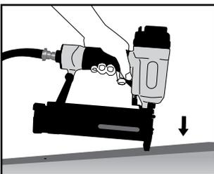
Maintenir l'outil pointé à l'écart de soi-même et des autres personnes, et raccorder l'outil à l'air comprimé.
