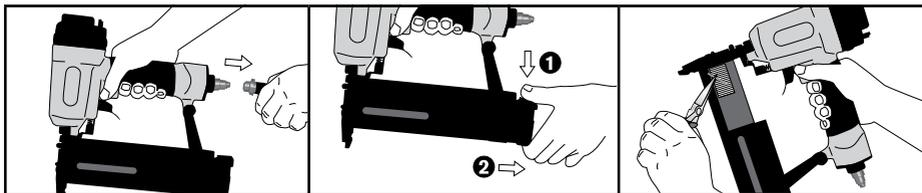
**KONSERWACJA:** Po odłączeniu narzędzia od zasilania sprężonym powietrzem przeprowadzić codzienną kontrolę w celu sprawdzenia swobody ruchu jarzma bezpieczeństwa i spustu.
