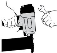
Koppel het pneumatisch gereedschap van de luchtdruk af voor u onderhoudswerkzaamheden uitvoert, een vastzittende nagel verwijdert, de werkplek verlaat, het gereedschap naar een andere plaats brengt of het apparaat aan iemand anders overdraagt. Gebruik het gereedschap niet als veiligheidsbeugel, trekker of veren ontbreken of onbruikbaar of beschadigd zijn. Zit niet aan veiligheidsjuk, trekker of veren en verwijder deze niet.
