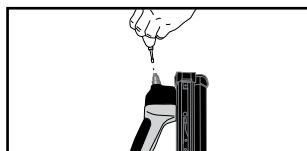
2 ili 3 kapljice ulja stavite u otvor za dovod zraka.
