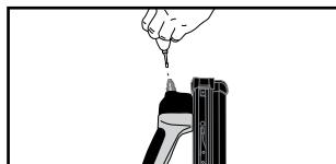
Wprowadzić lekko 2 lub 3 krople oleju do wlotu powietrza. Stosować wyłącznie olej dostarczany wraz z urządzeniem lub olej zalecany w części dane techniczne.
