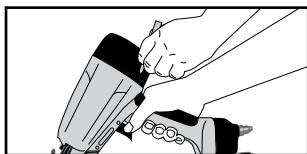
Всички винтове трябва да са затегнати. Разхлабени винтове водят до опасна работа и счупване на части.
