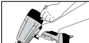
Alle schroeven moeten goed zijn aangehaald. Loszittende schroeven resulteren in een onveilige werking en het breken van onderdelen.
