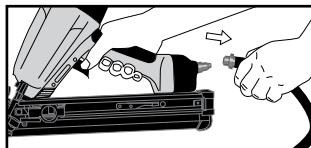
Débrancher l'outil de l'arrivée d'air comprimé.
