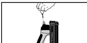
Spuit zachtjes 2 of 3 druppels olie in de luchtinlaat. Gebruik alleen de voor het gereedschap meegeleverde olie of de in de technische specificaties aanbevolen olie.
