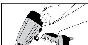
Alle Schrauben müssen fest angezogen sein. Lockere Schrauben führen zu einem unsicheren Betrieb und zur Beschädigung von Teilen.
