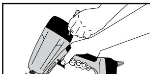
Все винты должны быть затянутыми. Ослабленные винты могут стать причиной опасности при эксплуатации и поломки деталей.
