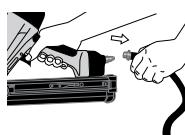
Couper l'arrivée d'air avant toute intervention sur l'appareil (maintenance ou dégagement d'un projectile coincé) ou avant de vous éloigner du secteur de travail ou avant de déplacer l'appareil, ou encore avant de le donner à une autre personne. Ne jamais utiliser l'outil si le dispositif de sécurité, la détente ou les ressorts ne sont pas opérationnels, ou sont manquants ou endommagés. Ne pas les altérer, ne pas les enlever.
