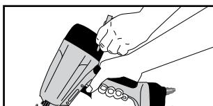
Alle skruer skal være trukket til. Løse skruer medfører usikker drift og skader på deler.
