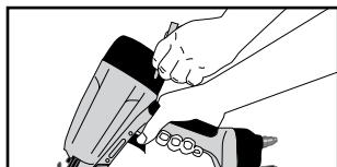
قم برش الزيت بخفة بمعدل 2 أو 3 قطرات زيت في مدخل الهواء.
