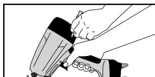
Alla skruvar ska sitta fast. Lösa skruvar kan resultera i osäker drift och att delar går sönder.
