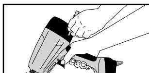
Alle skruer skal være fastspændte. Løse skruer resulterer i usikker betjening og brud på dele.
