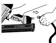
Отсоедините инструмент от системы подачи воздуха перед обслуживанием, извлечением застрявшей скобы, оставлением рабочей зоны, переносом инструмента в другое место или передачей другому лицу. Никогда не используйте инструмент, если предохранительный держатель, спусковая кнопка или пружины неисправны, отсутствуют или повреждены. Не пытайтесь вносить изменения в конструкцию или удалять предохранительный держатель, спусковую кнопку или пружины.
