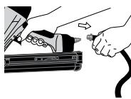
Разкачете инструмента от въздуха преди да извършите поддръжка, почистване от заседнати крепежни елементи, напускане на работното място, преместване на инструмента или предаване то му на друго лице. Никога не използвайте инструмента, ако обезопасителната скоба, спусъкът или пружините са станали неизползваеми, липсват или са повредени. Не правяйте и не премахвайте обезопасителната скоба, спусъка или пружините.
