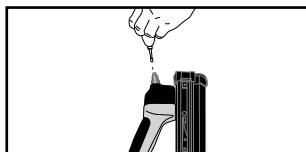
Lubrifier régulièrement légèrement l'outil en introduisant 2 à 3 gouttes d'huile par l'orifice d'entrée d'air comprimé. Utiliser l'huile fournie avec l'appareil ou les huiles recommandées dans les spécifications techniques.
