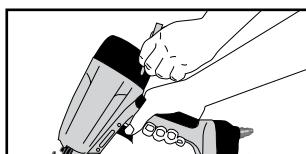
Toutes les vis doivent être maintenues serrées à fond. Les vis desserrées entraînent un manque de sécurité du fonctionnement et la rupture des pièces.
