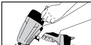
Todos los tornillos se deben mantener apretados. Los tornillos sueltos dan como resultado un funcionamiento inseguro y la rotura de las piezas.
