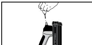
Добавьте 2-3 капли масла в воздухоприемник. Используйте только масло, поставляемое в комплекте с инструментом или рекомендуемое в технических спецификациях.
