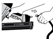
Prije izvođenja postupaka održavanja, uklanjanja prepreke prilikom blokirane sustava za zabijanje, napuštanja područja rada, prenošenja uređaja na drugu lokaciju ili predavanja uređaja drugoj osobi, uvijek odvojite uređaj od dovoda zraka. Uređaj ne koristite ako se sigurnosni obruč, okidač ili opruge pokvare, oštete ili nedostaju. Ne dirajte i ne uklanjajte sigurnosni obruč, okidač ili opruge.
