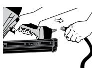
A karbantartás, elakadt rögzítő kivétele, a munkaterület elhagyása, a szerszám másik helyre történő áthelyezése vagy a szerszám másik ember által történő használata előtt válassza le a szerszámot a levegőforrásról.
