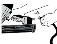
Před zahájením údržby, uvolňováním zaseknutého upínacího prvku, odchodu z pracovní oblasti, přesouváním nástroje do jiného umístění nebo předáním nástroje jiné osobě odpojte nástroj od přívodu vzduchu.
