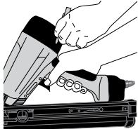
S'assurer que toutes les vis et les bouchons ou couvercles sont serrés en permanence. Par une injection journalière, s'assurer que la détente et le dispositif de sécurité par pression fonctionnent librement. Ne jamais utiliser l'outil si des pièces sont manquantes ou endommagées. Ne jamais utiliser un outil qui a des fuites d'air ou qui a besoin d'être réparé.
