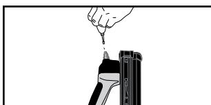
Ψεκάστε ελαφρά λάδι, 2 ή 3 σταγόνες λαδιού, μέσα στο στόμιο αέρα. Χρησιμοποιήστε μόνο το παρεχόμενο λάδι για το εργαλείο ή το συνιστώμενο λάδι από τις τεχνικές προδιαγραφές.
