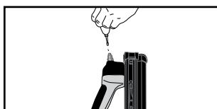
Do prívodu vzduchu jemne vstreknite 2 alebo 3 kvapky oleja. Používajte len olej dodávaný s nástrojom, prípadne olej odporúčaný podľa technických špecifikácií.
