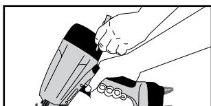
Todos os parafusos devem ser mantidos apertados. Os parafusos desapertados resulta numa operação insegura e em danos nas peças.
