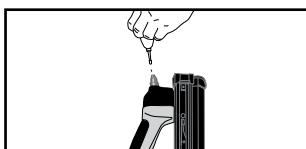
Iniettare con cautela 2-3 gocce d'olio nell'ingresso dell'aria. Utilizzare esclusivamente l'olio fornito con l'utensile o l'olio raccomandato nei dati tecnici.
