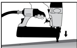
Nástrojem nemířte na sebe ani na ostatní a připojte jej k přívodu vzduchu. Nástroje je nutné používat při nejnižším tlaku potřebném pro dané použití. Snižte tak hladinu hluku, opotřebení dílů a spotřebu energie. Přitlačte špičku nástroje na obráběný dil, který chcete připevnit, a stisknutím spouště vystřelite skoby. Upravte minimální tlak, který je potřebný k proniknutí upínacích prvků. Poté provedte několik zkoušek. Začněte s nejnižším tlakem.
