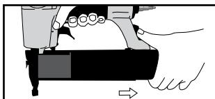
Lösen Sie das Magazin, indem Sie auf den Hebel drücken.
