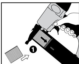
Laden von Drahtstiften: Halten Sie die Nagelpistole nach unten und laden Sie einen Streifen Nägel in die Kartusche, wobei die Spitzen nach unten weisen. Drücken Sie auf die Schiene, bis sie mit einem Klicken einrastet. Verwenden Sie nur empfohlene Befestigungselemente (siehe technische Daten).
