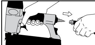
Odklopite orodje od dovoda zraka.
