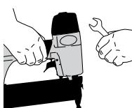
Atvienojet instrumentu no gaisa, pirms veicat instrumenta apkopi, iesprūdušas saspraudes izņemšanu, atstājot darba zonu, pārvietojot instrumentu uz citu vietu vai nododot to citai personai. Nekad nelietojet instrumentu, ja drošības sastiprinājums, mēlite vai atsperes ir nelietojami, pazuduši vai bojāti. Nepārveidojiet un nenonemiet drošības sastiprinājumu, mēlīti vai atsperes.
