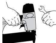
Desconecte del aire la herramienta antes de hacer el mantenimiento de la misma, liberar una fijación atascada, dejar el área de trabajo, desplazar la herramienta a otra ubicación, o traspasarla a otra persona. Nunca use la herramienta si los muelles, el disparador o el yugo de seguridad no funcionan, faltan o están dañados. No manipule ni quite el yugo de seguridad, el disparador ni los muelles.
