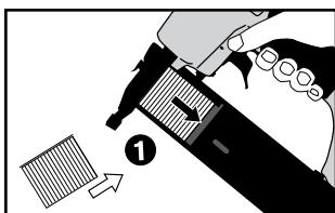
Plnění hřebíků: Podříte nastřelovací pistoli směrem dolů a vložte pás hřebíků do kazety tak, aby špičky směřovaly dolů. Zatlačte na madlo, dokud nezavakne v pozici. Použijte pouze doporučené upínací prvky (viz technické údaje).
