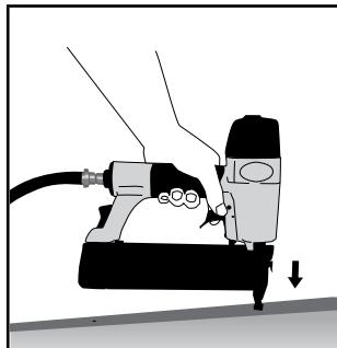
Держа инструмент направленным в сторону от себя и окружающих, присоедините его к системе подачи воздуха. Инструмент следует использовать при самом малом давлении, достаточном для приведения его в действие. Это позволит свести к минимуму уровень шума, износ деталей и потребление энергии.
