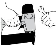
Couper l'arrivée d'air avant toute intervention sur l'appareil (maintenance ou dégagement d'un projectile coincé.) ou avant de vous éloigner du secteur de travail ou avant de déplacer l'appareil, ou encore avant de le donner à une autre personne. Ne jamais utiliser l'outil si le dispositif de sécurité, la détente ou les ressorts ne sont pas opérationnels, ou sont manquants ou endommagés. Ne pas les altérer, ne pas les enlever.
