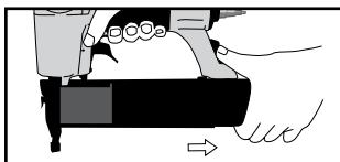
Otpustite spremnik pritiskom na polugu za otpuštanje.
