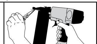
**APKOPE:** Kad instruments ir atvienots no gaisa padeves, ik dienas veiciet pārbaudi, lai nodrošinātu drošības sastiprinājuma un mēlites brīvu kustību. Visām skrūvēm jābūt cieši nostiprinātām. Valīgas skrūves ir iemesls nedrošam darbam un daļu bojājumiem. Iešlāciet 2 vai 3 eļļas pilites gaisa ieplūdē. Lietojiet tikai komplektā ieklāuto vai ieteicammo eļļu, kas norādīta tehniskajās specifikācijās. Uzturiet instrumentu tīru. Regulāri noslaukiet to ar sausu drānu un pārbaudiet nolietojumu.
