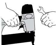
Před zahájením údržby, uvolňováním zaseknutého upínacího prvku, odchodu z pracovní oblasti, přesouváním nástroje do jiného umístění nebo předáním nástroje jiné osobě odpojte nástroj od přívodu vzduchu.
