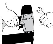
Отсоедините инструмент от системы подачи воздуха перед обслуживанием, извлечением застрявшей скобы, оставлением рабочей зоны, переносом инструмента в другое место или передачей другому лицу. Никогда не используйте инструмент, если предохранительный держатель, спусковая кнопка или пружины неисправны, отсутствуют или повреждены. Не пытайтесь вносить изменения в конструкцию или удалять предохранительный держатель, спусковую кнопку или пружины.
