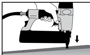
Orodje naj bo usmerjeno stran od vas in drugih. Priklučite orodje na dovod zraka. Orodje uporabljajte pri najnižjem tlaku, ki je potreben za uporabo. Tako boste zmanjšali raven hrupa, obrabo delov in porabo energije. Konico orodja potisnite na obdelovanec, ki ga želite pritrdirti in pritisnite sprožilec, da izstopijo sponke. Dodajte zgoj minimalni tlak, ki je potreben za prodiranje sponk. Nato naredite nekaj preizkusov, pri čemer začnite pri najnižjem tlaku.
