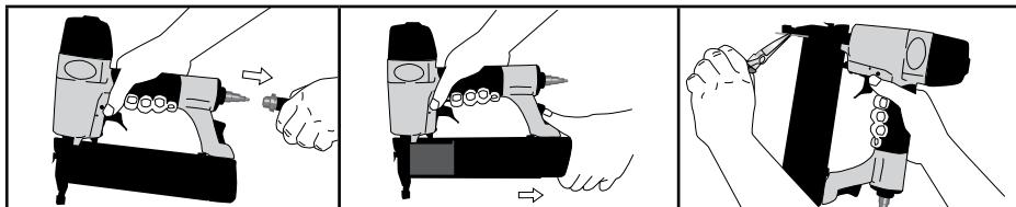
**KONSERWACJA:** Po odłączeniu narzędzia od zasilania sprężonym powietrzem przeprowadzić codzienną kontrolę w celu sprawdzenia swobody ruchu jarzma bezpieczeństwa i spustu.
