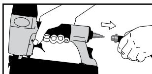
Débrancher l'outil de l'arrivée d'air comprimé.
