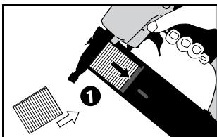
Ladda spik: Håll spikpistolen nedåt och ladda ett spikband i kassetten med spetsarna nedåt. Tryck på skenan tills den klickar på plats. Använd bara rekommenderade förband (se de tekniska specifikationerna).
