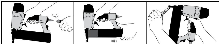
**MANTENIMIENTO:** Mientras la herramienta está desconectada del suministro de aire, haga una inspección diaria para asegurarse del libre movimiento del yugo de seguridad y del disparador. Todos los tornillos se deben mantener apretados. Los tornillos sueltos dan como resultado un funcionamiento inseguro y la rotura de las piezas.
