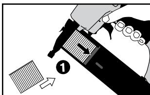
Naulojen lisääminen: Pidä naulainta alas päin ja lisää naularivi säiliöön naulojen kärki alas päin. Työnnä kiskoa, kunnes se napsahtaa paikalleen. Käytä vain suosittelulta sinkilöitä (katso tekniset tiedot).
