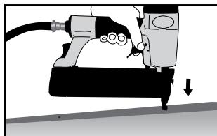
Uredaj ne okrećite prema sebi ili drugima i spojite ga na dovod zraka. Uredaj će se koristiti pod najmanjim tlakom potrebnim za željenu radnju. To će smanjiti razinu buke, habanje dijelova i uporabu energije. Nos uređaja pritisnite na radni materijal koji se treba pričvrstiti te pritisnite okidač da biste ispalili spojku(e). Podesite min. tlak potreban za prodiranje spojki. Zatim obavite probno spajanje koristeći najniži tlak.
