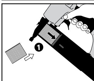
Laden van brads: Houd het niet-pistool omlaag en laad een strip nieten in de cassette, met de punten omlaag gericht. Druk op de rail totdat deze op zijn plek klikt. Gebruik uitsluitend de aanbevolen nagels (zie de technische specificaties).
