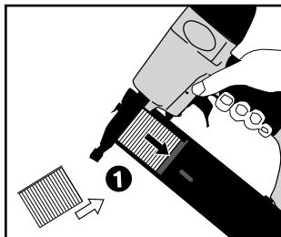
Chargement en pointes : tout en maintenant le cloueur dirigé vers le bas, mettre une bande de pointes dans le chargeur en mettant la pointe des clous contre le bas du chargeur. Repousser le rail jusqu'à encliquetage. N'utiliser que des projectiles d'origine (voir les spécifications techniques).
