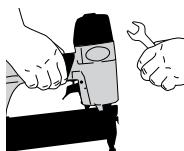
Prije izvođenja postupaka održavanja, uklanjanja prepreke prilikom blokirane sustava za zabijanje, napuštanja područja rada, prenošenja uređaja na drugu lokaciju ili predavanja uređaja drugoj osobi, uvijek odvojite uređaj od dovoda zraka. Uređaj ne koristite ako se sigurnosni obruč, okidač ili opruge pokvare, oštete ili nedostaju. Ne dirajte i ne uklanjajte sigurnosni obruč, okidač ili opruge.
