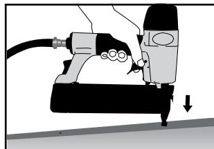
Houd het gereedschap van uzelf en anderen af en sluit het aan op de luchttvoer. Gebruik gereedschap bij de voor de betreffende toepassing laagst mogelijke druk. Dat zorgt voor een lager geluidsniveau, minder slijtage en een lager energieverbruik. Druk de neus van het gereedschap op het vast te zetten werkstuk en haal de trekker over om nieten af te schieten. Stel de voor het binnendringen van de nagels benodigde minimumdruk af. Voer vervolgens een aantal starttesten uit met de laagste druk.
