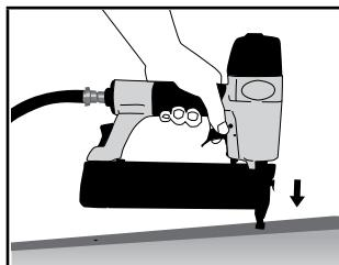
Maintenir l'outil pointé à l'écart de soi-même et des autres personnes, et raccorder l'outil à l'air comprimé.
