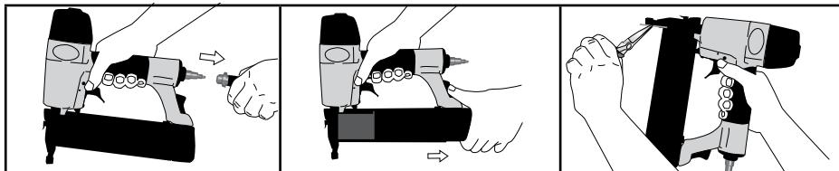
**MANUTENÇÃO:** Enquanto a ferramenta estiver desligada do fornecimento de ar, faça a inspecção diária para se certificar do movimento livre do dispositivo de segurança e do gatilho.
