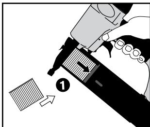
Carga de grapas: Dé la vuelta a la pistola. Cargue una tira de grapas en el cargador, con las puntas hacia abajo. A continuación, para cerrar el cargador presione completamente hacia arriba. Use solamente fijaciones recomendadas (ver especificaciones técnicas).
