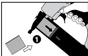
Vstavljanje žebljev: žebljalnik obrnите navzdol in vstavite komplet žebljev v kartušo, tako da bodo konice gledale navzdol. Pritisnite vodilo, da zaskoči. Uporabljajte samo priporočene sponke (glejte tehnične specifikacije).
