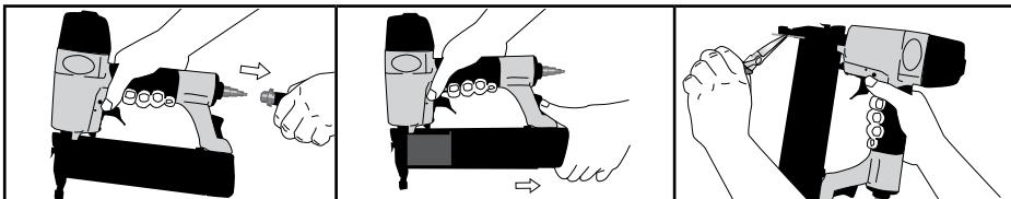
**ОБСЛУЖИВАНИЕ:** Пока инструмент отсоединен от системы подачи воздуха, производите ежедневный осмотр на предмет свободного движения предохранительного держателя и спусковой кнопки.
