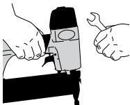
Koppel het pneumatisch gereedschap van de luchtdruk af voor u onderhoudswerkzaamheden uitvoert, een vastzittende nagel verwijdert, de werkplek verlaat, het gereedschap naar een andere plaats brengt of het apparaat aan iemand anders overdraagt. Gebruik het gereedschap niet als veiligheidsbeugel, trekker of veren ontbreken of onbruikbaar of beschadigd zijn. Zit niet aan veiligheidsjuk, trekker of veren en verwijder deze niet.
