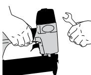
A karbantartás, elakadt rögzítő kivétele, a munkaterület elhagyása, a szerszám másik helyre történő áthelyezése vagy a szerszám másik ember által történő használata előtt válassza le a szerszámot a levegőforrásról.
