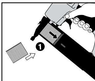
Загрузка гвоздей: Держите пистолет в направлении вниз и вставьте полоску гвоздей в картридж, так чтобы острые концы были направлены вниз. Нажимайте на направляющую рейку, пока она не зафиксируется со щелчком. Используйте только рекомендуемые гвозди (см. технические спецификации).
