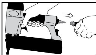
Odlączyć urządzenie od zasilania sprężonym powietrzem.
