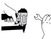
Couper l'arrivée d'air avant toute intervention sur l'appareil (maintenance ou dégagement d'un projectile coincé.) ou avant de vous éloigner du secteur de travail ou avant de déplacer l'appareil, ou encore avant de le donner à une autre personne. Ne jamais utiliser l'outil si le dispositif de sécurité, la détente ou les ressorts ne sont pas opérationnels, ou sont manquants ou endommagés. Ne pas les altérer, ne pas les enlever.
