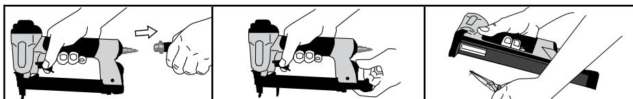
**APKOPE:** Kad instruments ir atvienots no gaisa padeves, ik dienas veiciet pārbaudi, lai nodrošinātu drošības sastiprinājuma un mēlītes brīvu kustību. Visām skrūvēm jābūt cieši nostiprinātām. Valīgas skrūves ir iemesls nedrošam darbam un daļu bojājumiem. Iešlāciet 2 vai 3 eļļas pilites gaisa ieplūdē. Lietojet tikai komplektā iekārtu vai ieteicammo eļļu, kas norādīta tehniskajās specifikācijās.
