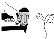
Prije izvođenja postupaka održavanja, uklanjanja prepreke prilikom blokirane sustava za zabijanje, napuštanja područja rada, prenošenja uređaja na drugu lokaciju ili predavanja uređaja drugoj osobi, uvijek odvojite uređaj od dovoda zraka.
