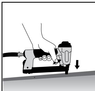
Halten Sie das Werkzeug von sich und anderen Personen entfernt und schließen Sie es an die Druckluftversorgung an.
