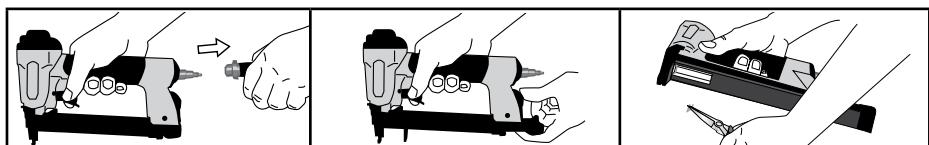
**BAKIM:** Aletin hava kaynağı bağlantısı çıkarılmış olarak, emniyet kelepçesinin ve tetiğin serbest hareket ettiğini kontrol edin. Tüm vidalar sıkı olmalıdır. Gevşek vidalar çalışma emniyetini ortadan kaldırır ve parçaların bozulmasına neden olur. Hava girişine 2 veya 3 damla yağ damlatın.
