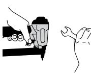
A karbantartás, elakadt rögzítő kivétele, a munkaterület elhagyása, a szerszám másik helyre történő áthelyezése vagy a szerszám másik ember által történő használata előtt válassza le a szerszámat a levegőforrásról.
