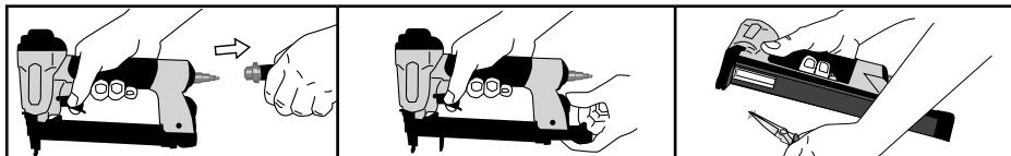
**UNDERHÅLL:** Undersök dagligen att avtryckaren och säkerhetsreläet kan röras fritt. Verktyget ska under tiden vara bortkopplat från tryckluften.
