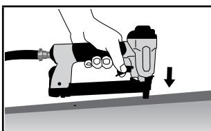
Varmista, että työkalua ei ole suunnattu itseäsi tai muita kohden, ja kytke paineilma työkaluun. Työkaluja on käytettävä alhaisimalla käyttötarkoitukseen sopivalla paineella. Tämä vähentää melutsoa, osien kulumista ja energiankulutusta. Paina työkalun nokka työstettävään esineeseen ja kiinnitä sinkilät painamalla liipaisinta. Säädä sinkilöiden kiinnittämiseen tarvittavaa vähimmäispainetta. Kokeile sitten kiinnittämistä alhaisimalla paineella.
