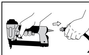
Trennen Sie das Werkzeug von der Druckluftversorgung ab.
