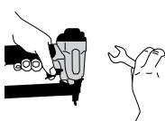
Отсоедините инструмент от системы подачи воздуха перед обслуживанием, извлечением застрявшей скобы, оставлением рабочей зоны, переносом инструмента в другое место или передачей другому лицу. Никогда не используйте инструмент, если предохранительный держатель, спусковая кнопка или пружины неисправны, отсутствуют или повреждены. Не пытайтесь вносить изменения в конструкцию или удалять предохранительный держатель, спусковую кнопку или пружины.
