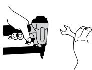
Разкачете инструмента от въздуха преди да извършите поддръжка, почистване от заседнати крепежни елементи, напускане на работното място, преместване на инструмента или предаване то му на друго лице. Никога не използвайте инструмента, ако обезопасителната скоба, спусъкът или пружините са станали неизползваеми, липсват или са повредени. Не правяйте и не премахвайте обезопасителната скоба, спусъка или пружините.
