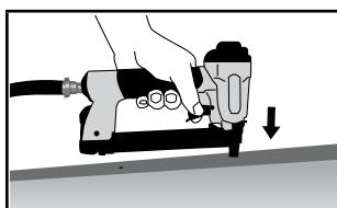
Nástrojem nemířte na sebe ani na ostatní a připojte jej k přívodu vzduchu. Nástroje je nutné používat při nejnižším tlaku potřebném pro dané použití. Snižte tak hladinu hluku, opotřebení dílů a spotřebu energie. Přitlačte špičku nástroje na obráběný dil, který chcete připevnit, a stisknutím spouště vystřelite skoby. Upravte minimální tlak, který je potřebný k proniknutí upínacích prvků. Poté provedte několik zkoušek. Začněte s nejnižším tlakem.
