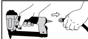
Odklopite orodje od dovoda zraka.
