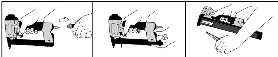
**MANUTENÇÃO:** Enquanto a ferramenta estiver desligada do fornecimento de ar, faça a inspecção diária para se certificar do movimento livre do dispositivo de segurança e do gatilho.
