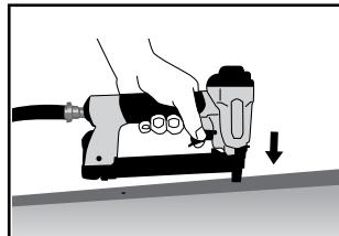
Houd het gereedschap van uzelf en anderen af en sluit het aan op de luchttvoer. Gebruik gereedschap bij de voor de betreffende toepassing laagst mogelijke druk. Dat zorgt voor een lager geluidsniveau, minder slijtage en een lager energieverbruik. Druk de neus van het gereedschap op het vast te zetten werkstuk en haal de trekker over om niets af te schieten. Stel de voor het binnendringen van de nagels benodigde minimumdruk af. Voer vervolgens een aantal starttesten uit met de laagste druk.
