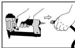
Odlączyć urządzenie od zasilania sprężonym powietrzem.
