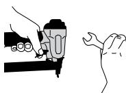
Desconecte del aire la herramienta antes de hacer el mantenimiento de la misma, liberar una fijación atascada, dejar el área de trabajo, desplazar la herramienta a otra ubicación, o traspasarla a otra persona. Nunca use la herramienta si los muelles, el disparador o el yugo de seguridad no funcionan, faltan o están dañados. No manipule ni quite el yugo de seguridad, el disparador ni los muelles.
