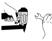
Atvienojet instrumentu no gaisa, pirms veicat instrumenta apkopi, iesprūdušas saspraudes izņemšanu, atstājot darba zonu, pārvietojot instrumentu uz citu vietu vai nododot to citai personai. Nekad nelietojet instrumentu, ja drošības sastiprinājums, mēlite vai atsperes ir nelietojami, pazuduši vai bojāti. Nepārveidojiet un nenonemiet drošības sastiprinājumu, mēlīti vai atsperes.
