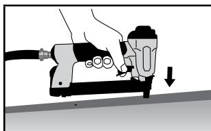
Orodje naj bo usmerjeno stran od vas in drugih. Priklučite orodje na dovod zraka. Orodje uporabljajte pri najnižjem tlaku, ki je potreben za uporabo. Tako boste zmanjšali raven hrupa, obrabo delov in porabo energije. Konico orodja potisnite na obdelovanec, ki ga želite pritrdirti in pritisnite sprožilec, da izstopijo sponke. Dodajte zgoj minimalni tlak, ki je potreben za prodiranje sponk. Nato naredite nekaj preizkusov, pri čemer začnite pri najnižjem tlaku.
