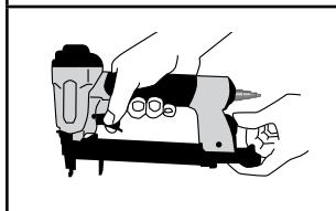
Lösen Sie das Magazin, indem Sie auf den Hebel drücken.
