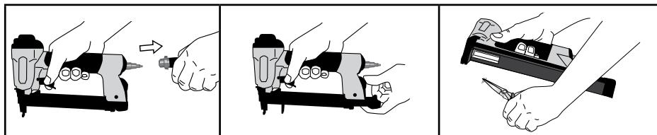
**WARTUNG:** Prüfen Sie das Werkzeug bei abgetrennter Druckluftversorgung täglich auf freie Beweglichkeit von Auslösesicherung und Auslöseschalter.
