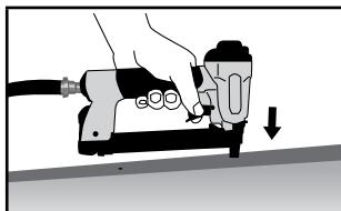
Uredaj ne okrećite prema sebi ili drugima i spojite ga na dovod zraka. Uredaj će se koristiti pod najmanjim tlakom potrebnim za željenu radnju. To će smanjiti razinu buke, habanje dijelova i uporabu energije. Nos uređaja pritisnite na radni materijal koji se treba pričvrstiti te pritisnite okidač da biste ispalili spojku(e). Podesite min. tlak potreban za prodiranje spojki. Zatim obavite probno spajanje koristeći najniži tlak.
