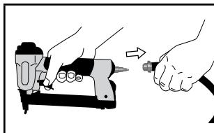
Débrancher l'outil de l'arrivée d'air comprimé.
