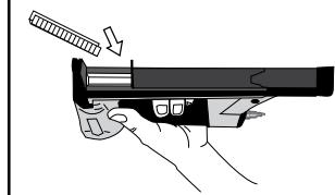
Ładowanie zszywek: Obrócić zszywarkę dolną częścią do góry. Załadować taśmę zszywek do magazynku, ostrzami skierowanymi w dół. Następnie zamknąć magazynek, naciskając go do oporu w góre.
