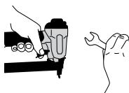
Koppel het pneumatisch gereedschap van de luchtdruk af voor u onderhouds-werkzaamheden uitvoert, een vastzittende nagel verwijdert, de werkplek verlaat, het gereedschap naar een andere plaats brengt of het apparaat aan iemand anders overdraagt. Gebruik het gereedschap niet als veiligheidsbeugel, trekker of veren ontbreken of onbruikbaar of beschadigd zijn. Zit niet aan veiligheidsjuk, trekker of veren en verwijder deze niet.
