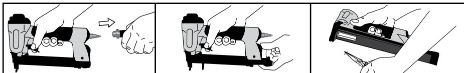
**ОБСЛУЖИВАНИЕ:** Пока инструмент отсоединен от системы подачи воздуха, производите ежедневный осмотр на предмет свободного движения предохранительного держателя и спусковой кнопки.
