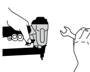
Pred údržbou, uvoľňovaním zaseknutého spojovacieho materiálu, predtým než odchádzate z pracoviska, keď prenášate nástroj na iné pracovisko, alebo keď podávate nástroj inej osobe, vždy odpojte prívod stlačeného vzduchu. Nikdy nepoužívajte nástroj ak nefungujú, chýbajú, alebo sú poškodené bezpečnostný popruh, spúšť, alebo pružiny. Nemanipulujte ani nedemontujte bezpečnostný popruh, spúšť ani pružiny.
