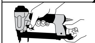
Otpustite spremnik pritiskom na polugu za otpuštanje.
