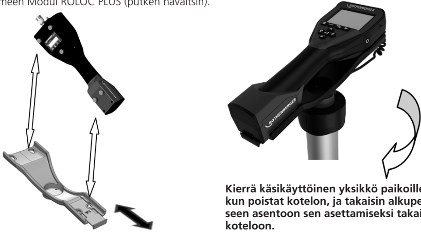
Kuva 4 - Miten käsiyksikkö ROSCOPE 1000/i2000 asetetaan pidikkeeseen
