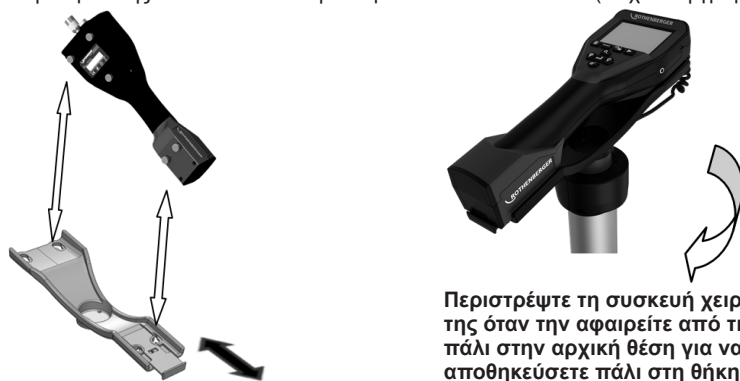
Εικόνα 4 - Εγκατάσταση της μονάδας χειρός ROSCOPE 1000/i2000 στη βάση στερέωσης
