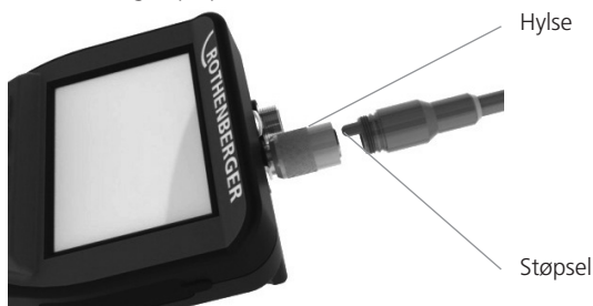
Figur 2 - Kabelkontakter (kontakt type A, svart)
