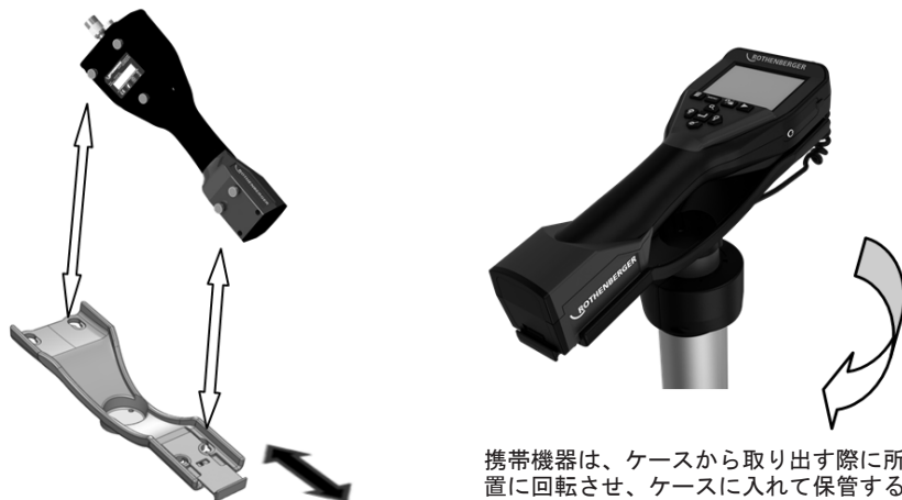
図 4 - ROSCOPE 1000/i2000 携帯装置を実装架台に取り付ける
