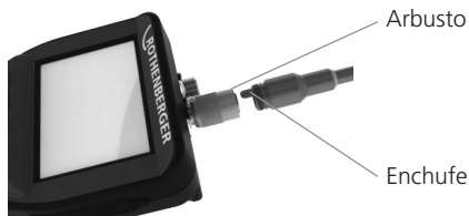
Figura 2 - Cableado (Conector de estilo A negro)
