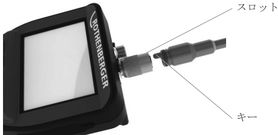
図4 - ケーブルの接続 (コネクタ式A, 黒色)
