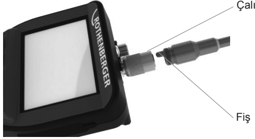
Şekil 4 - Kablo Bağlantıları (Style A Konektör, Siyah)
