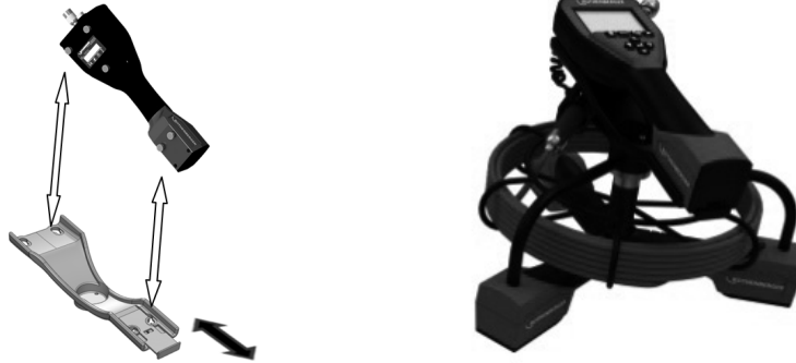
Şekil 6 - Elle kullanılan ROSCOPE 1000/i2000 ünitesinin montaj kızağına yerleştirilmesi
