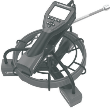
Şekil 1 - Modul 25/16 (No. 1500000052) Sistem Bileşenleri
