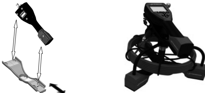
Figur 6 – Installering av ROSCOPE 1000/i2000 handverktyg på monteringshållaren
