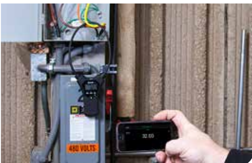
CM57 har stöd för Bluetooth och ger därmed möjlighet till avläsning på säkert avstånd
