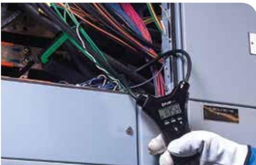
FLIR CM57 har en flexibel kabel som lämpar sig i trånga utrymmen
