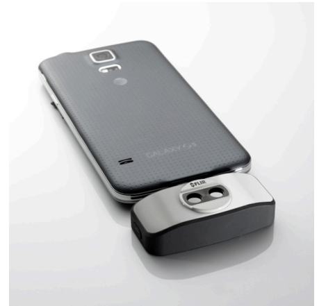
Figur 13.3 2015: FLIR One, ett tillbehör till iPhone- och Android-mobiltelefoner. Vikt: 90 g.
