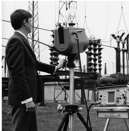
Figur 13.2 1969: Thermovision-modell 661. Kameran vägde cirka 25 kg, oscilloskopet 20 kg och stativet 15 kg. Operatören behövde dessutom en 220 V växelströmshögspänning och en 10-litersbehållare med flytande kväve. Till vänster om oscilloskopet syns Polaroidtillsatsen (6 kg).
