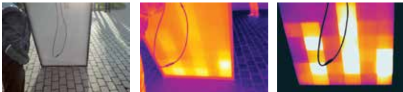
Bilder tagna från baksidan av en solcellspanel visar mycket mindre reflektion än framsidan, vilket gör temperaturmätningen betydligt mer noggrann.
