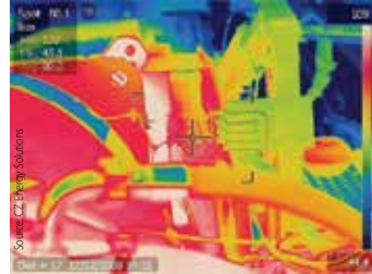
En termografiinspektion av en vindturbin. Inspektionen gjordes på cirka 50 meters höjd.
