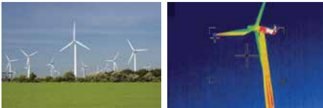
En värmebild över ett vindkraftverk, taget från marken.
