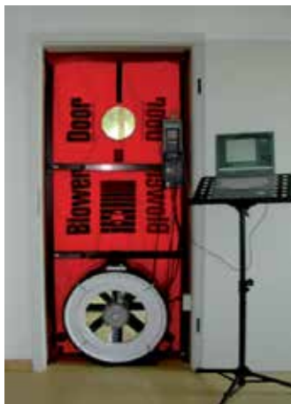
BlowerDoor-utrustning är vanligtvis installerad i ytterdörren.
