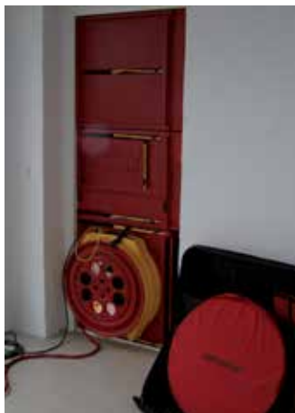
BlowerDoor-utrustning är vanligtvis installerad i ytterdörren.
