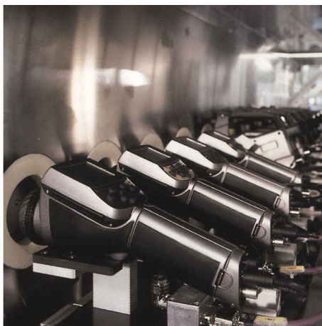
Figur 11.5 TILL VÄNSTER: Provning av värmekameror i vår klimatkammare; TILL HÖGER: Robot för provning och kalibrering av kameror.
