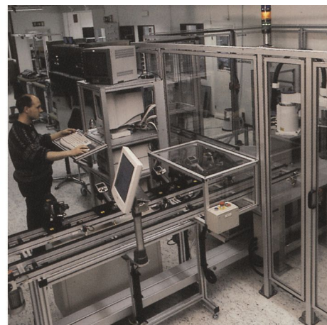
Figur 11.5 TILL VÄNSTER: Provning av värmekameror i vår klimatkammare; TILL HÖGER: Robot för provning och kalibrering av kameror.
