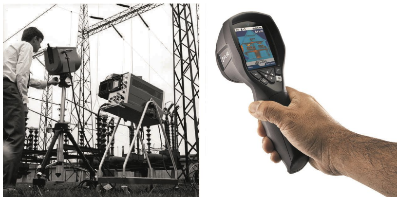
Figur 11.2 VÄNSTER: Thermovision-modell 661 från 1969. Kameran vägde cirka 25 kg, oscilloskopet 20 kg och stativet 15 kg. Operatören behövde dessutom en 220 V växelströmsgenerator och en 10-liters-behållare med flytande kväve. Till vänster om oscilloskopet syns Polaroidtillsatsen (6 kg). HÖGER: Flir i7 från 2012. Vikt: 0,34 kg med batteri.
