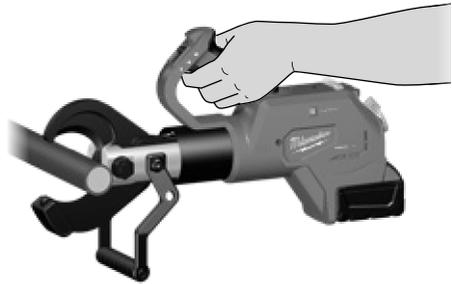
2. Drücken Sie den Auslöser und halten Sie ihn gedrückt bis die Schneiden am Kabelaußendurchmesser anliegen. (2)
