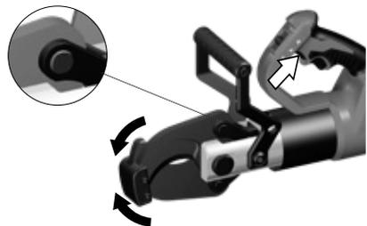
2. Entfernen Sie die Batterien und ziehen Sie den Schiebeschalter in Verriegelungsposition.
