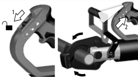
3. Wenn der Schnitt durchgeführt ist, betätigen Sie den Rückstellschalter, damit sich die Schneidbacken öffnen. (3) Ziehen sie den Schaltschieber in die Verriegelungsposition. (4)
