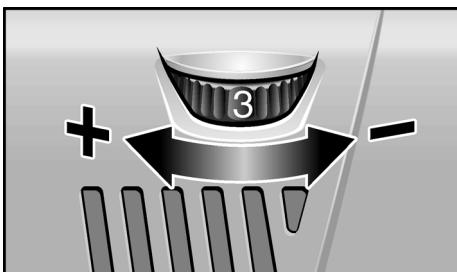
W celu nastawienia roboczej liczby obrotów przekrącić kółko nastawnika na odpowiednią wartość.
