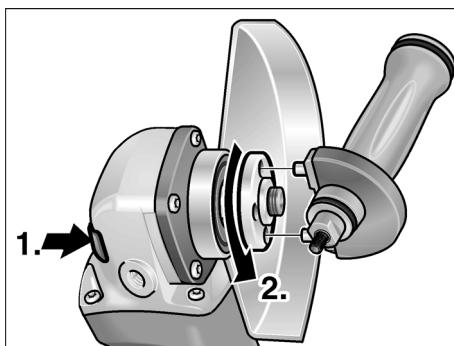
4. Нажмите на фиксатор шпинделя и не отпускайте его (1.).
