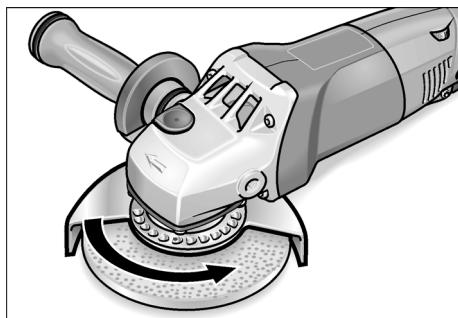
2. Поверните защитный кожух (4a), повышающий безопасность работы, в направлении, противоположном направлению вращения двигателя, указанному стрелкой на приводной головке (7), и установите его в необходимое положение.
