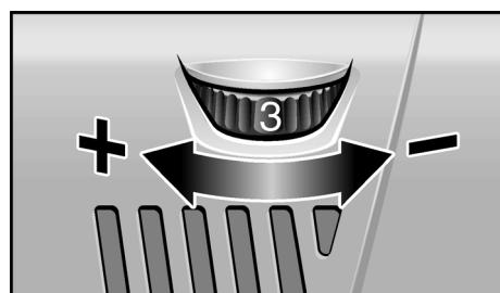
K nastavení pracovních otáček nastavte nastavovací kolečko na požadovanou hodnotu.
