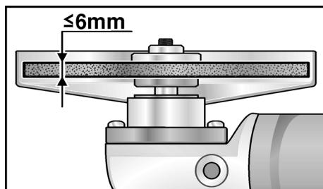
7. Skruva fast spännmuttern (3a) på spindeln med flänsen riktad uppåt.
