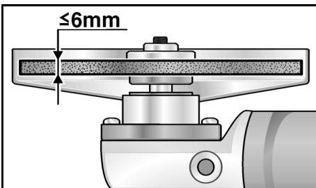
7. Spannmutter (3a) mit dem Bund nach oben auf die Spindel schrauben.
