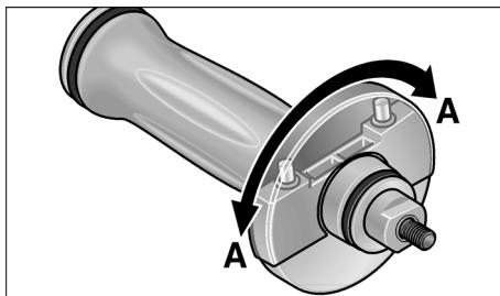
3. Поверните имеющуюся на рукоятке крышку на 180° до фиксации. Теперь стопорный ключ открыт.
