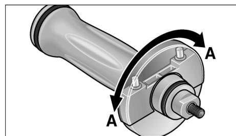
3. Ruotare la copertura dell'impugnatura di 180° fino all'innesto.
