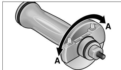
3. Rodar a cobertura do punho em 180°, até ao encaixe. A chave de detenção faz parte do equipamento.
