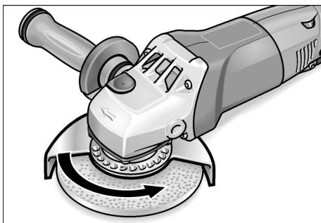
2. Drej sikkerheds-beskyttelseshætten (4a) i modsat retning af omdrejningsretningspilen på gearhovedet (7) og hen til ønsket position.
