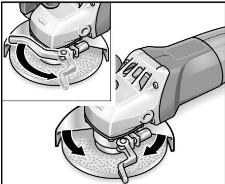
2. Desapertar a alavanca de fixação.
