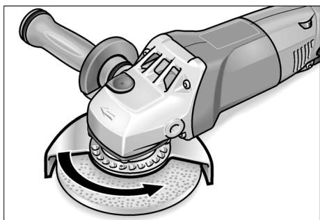
2. Tournez le capot de protection de sécurité (4a) en sens inverse de la flèche directionnelle apposée sur la boîte d'engrenages (7), jusqu'à atteindre la position voulue.
