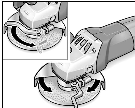
2. Aflojar la palanca de montaje.
