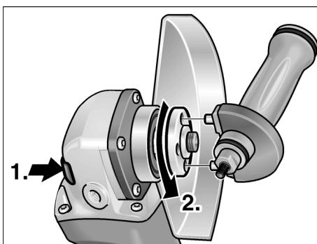
4. Appuyez sur le dispositif de blocage de la broche et maintenez-le appuyé (1.).
