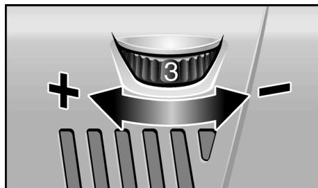
Radi namještanja radnog broja okretaja kotač za namještanje postaviti na željenu vrijednost.
