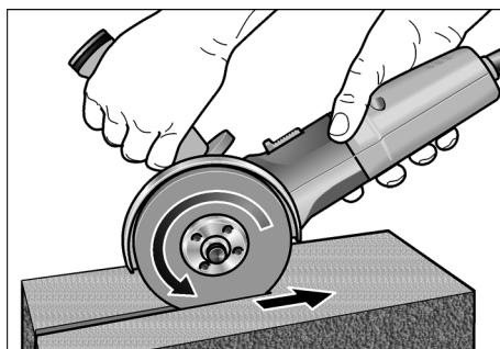
– Ο γωνιακός λειαντήρας πρέπει να λειτουργεί πάντοτε σε αντίθετη πορεία, βλ. εικόνα.
