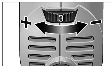
Para ajustar la velocidad de trabajo, girar la rueda de ajuste al valor deseado.
