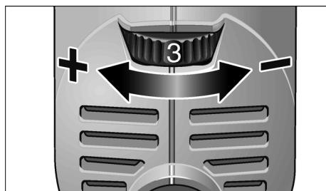
Na nastavenie pracovných otáčok nastavte nastavovacie koliesko na požadovanú hodnotu.
