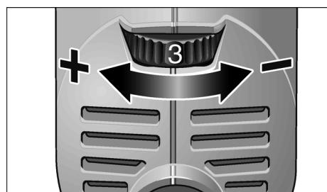
W celu nastawienia roboczej liczby obrotów przekrącić kółko nastawnika na odpowiednią wartość.
