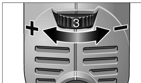
K nastavení pracovních otáček nastavte nastavovací kolečko na požadovanou hodnotu.
