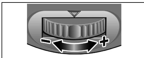
Para ajustar la cantidad de carreras, colocar la rueda de ajuste en el valor deseado.
