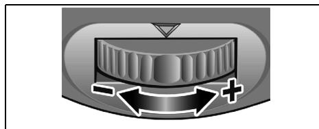
Для установки скорости хода поверните ручку регулировки на желаемое значение.
