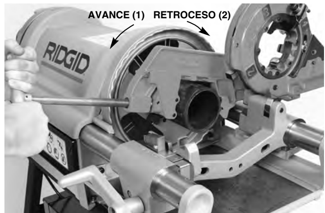
Figura 21 – Corte de un tubo con el cortador 764: rotación de la máquina
