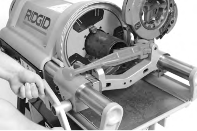
Şekil 22 – Raybalama Makinesiyle Boru Raybalama
