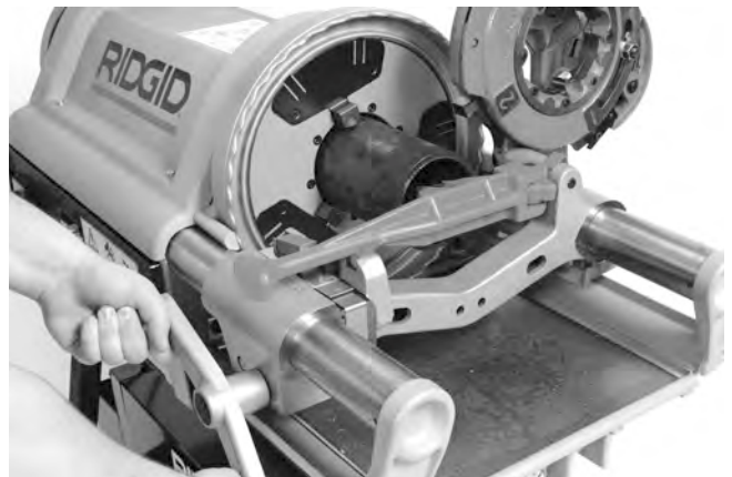
Рис. 22 – Зенкование трубы с использованием зенковки
