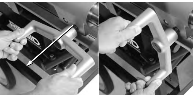
Figura 20 – Ajuste del volante del carro
