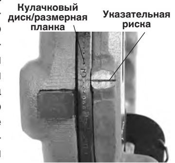
Рис. 14 – Настройка размера резьбы
