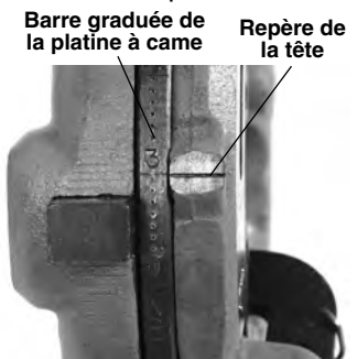
Figure 14 – Réglage du pas de filetage
