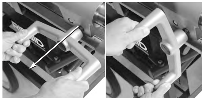
Рис. 20 – Регулировка положения ручного маховичка каретки
