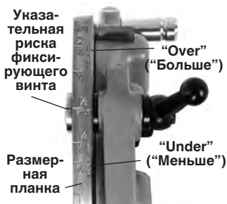
Рис. 10 – Настройка размера резьбы
