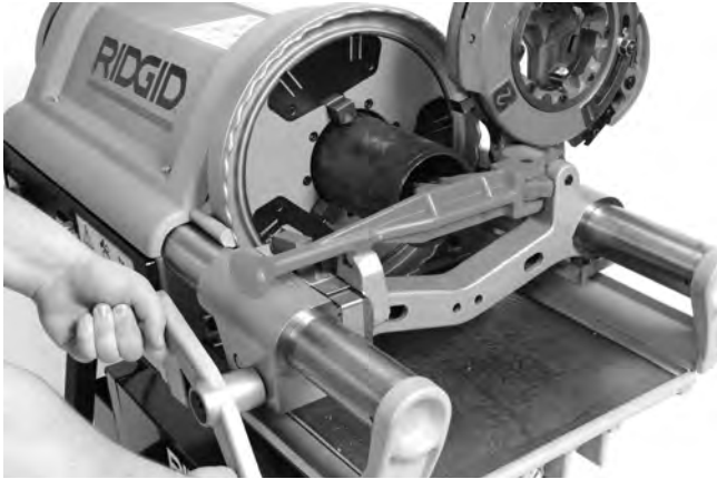
Figura 22 – Escariado de un tubo con el escariador
