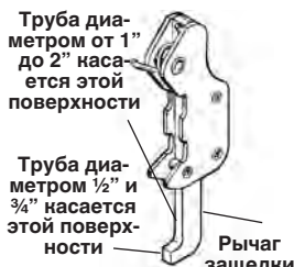
Рис. 11 – Регулировка положения защелки
