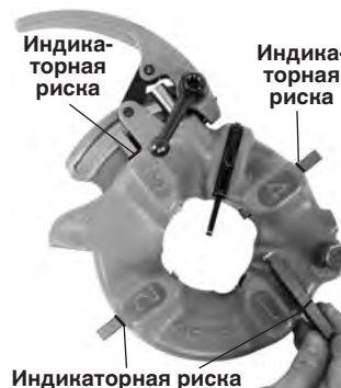
Рис. 9 – Вставка резьбонарезных гребенок
