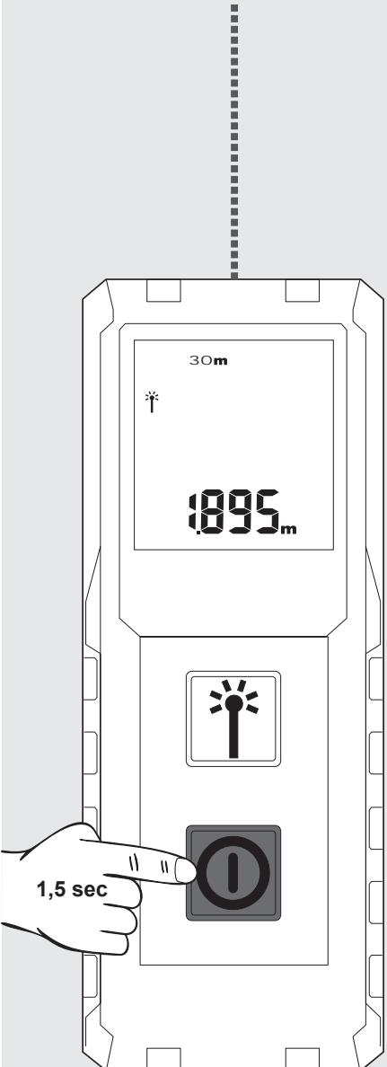
За да замразите измерването, натиснете бутона за измерване.
