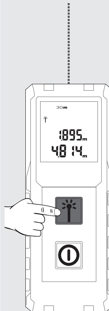
Stiskněte znova tlačítko měření, abyste spustili další měření. Předcházející měření se přesune do pole nad.
