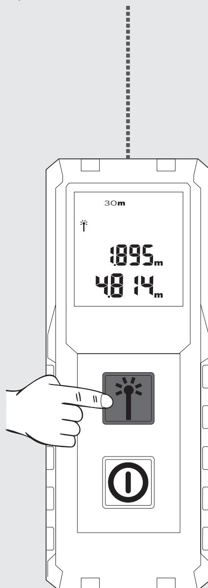
Apăsați din nou tasta Măsurare, pentru a porni o nouă măsurare. Măsurarea anterioară este deplasată în câmpul de memorare superior.
