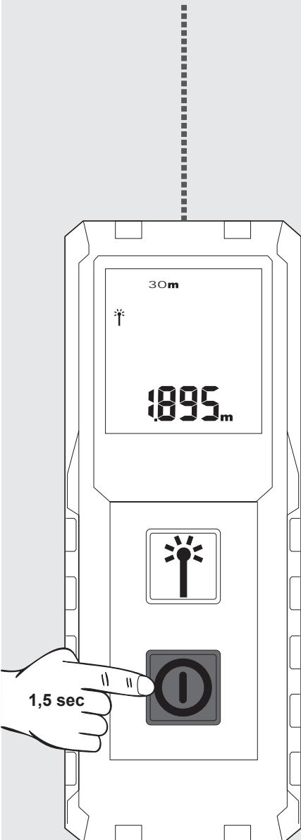
Aby zapisać pomiar, należy wcisnąć przycisk pomiaru.
