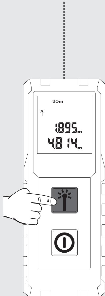
Πιέστε πάλι το πλήκτρο μέτρησης, για να ξεκινήσετε μια νέα μέτρηση. Η προηγούμενη μέτρηση μετατοπίζεται στο πεδίο απομνημόνευσης από πάνω.
