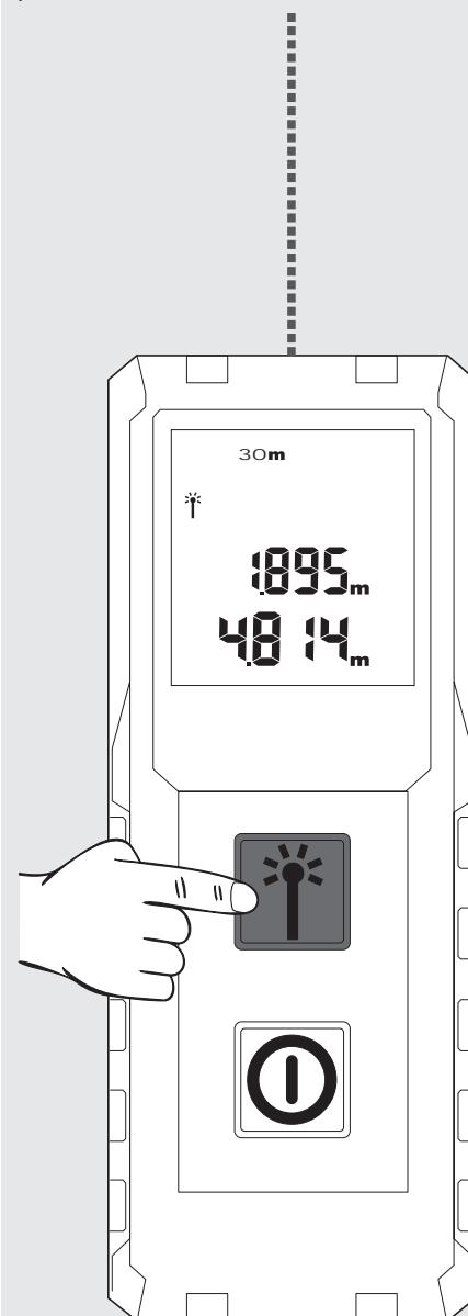
Aby rozpocząć kolejny pomiar, należy wcisnąć ponownie przycisk pomiaru. Poprzedni pomiar zostaje przesunięty do pola historii.
