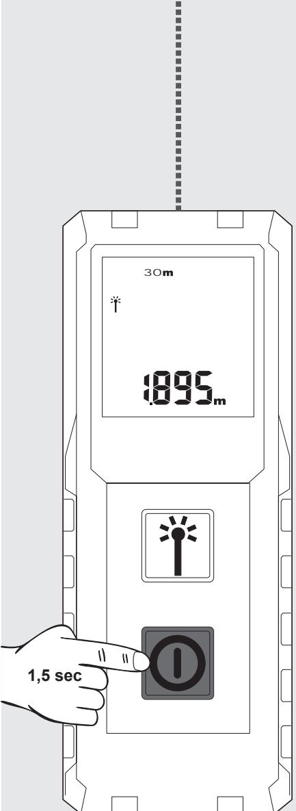
Για το πάγωμα της μέτρησης πιέστε το πλήκτρο μέτρησης.
