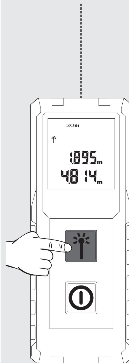
Lai sāktu jaunu mērījumu, vēlreiz nospiediet mērīšanas taustiņu. Iepriekšējais mērījums tiek pārbīdīts uz augšā esošo atmiņas laukumu.
