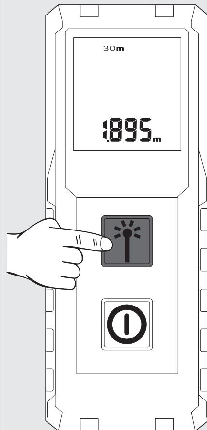
Снова нажмите кнопку измерения, чтобы начать следующее измерение.
