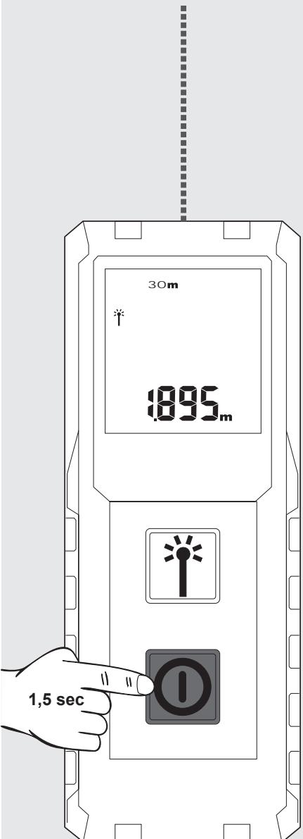
Ölçümü dondurmak için ölçüm tuşuna basınız.
