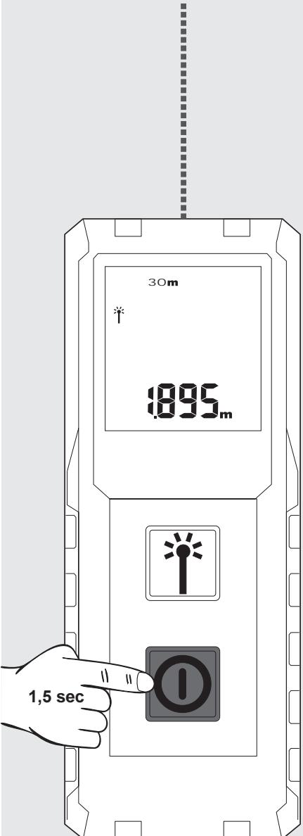
A mérés befagyasztásához nyomja meg a mérés gombot.
