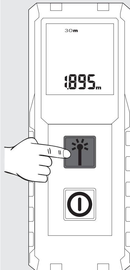
Apăsați din nou tasta Măsurare, pentru a porni o nouă măsurare. Măsurarea anterioară este deplasată în câmpul de memorare superior.
