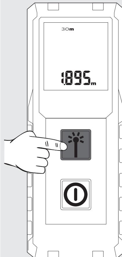
További mérés indításához nyomja meg ismét a mérés gombot. Az előző mérés az előzmény mezőbe kerül.
