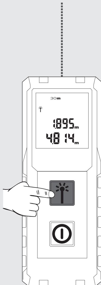
Appuyer de nouveau sur la touche Mesure pour démarrer une nouvelle mesure. La mesure précédente sera déplacée dans le champ de mémoire au dessus.
