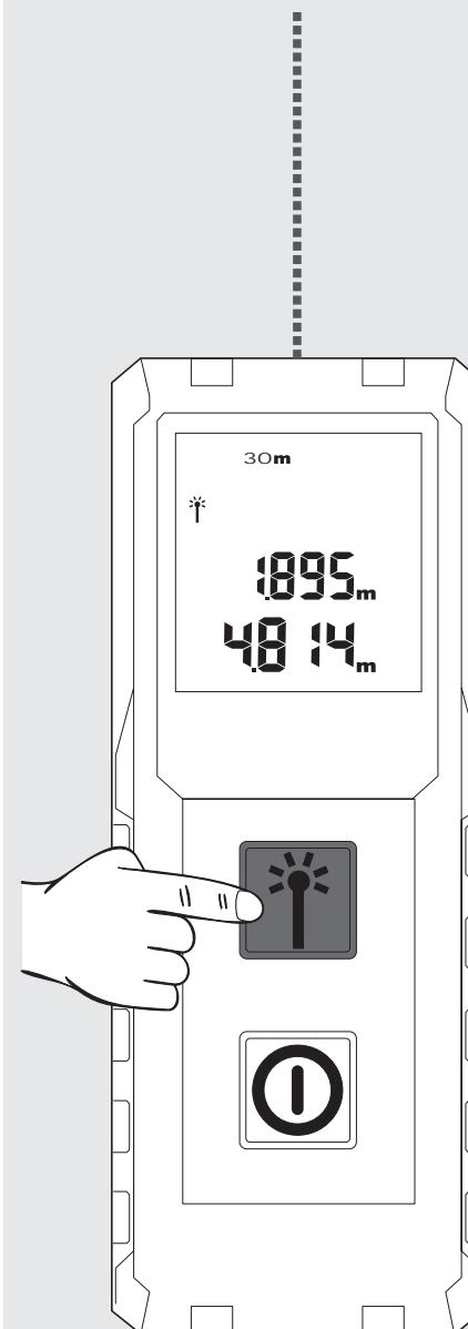
További mérés indításához nyomja meg ismét a mérés gombot. Az előző mérés az előzmény mezőbe kerül.
