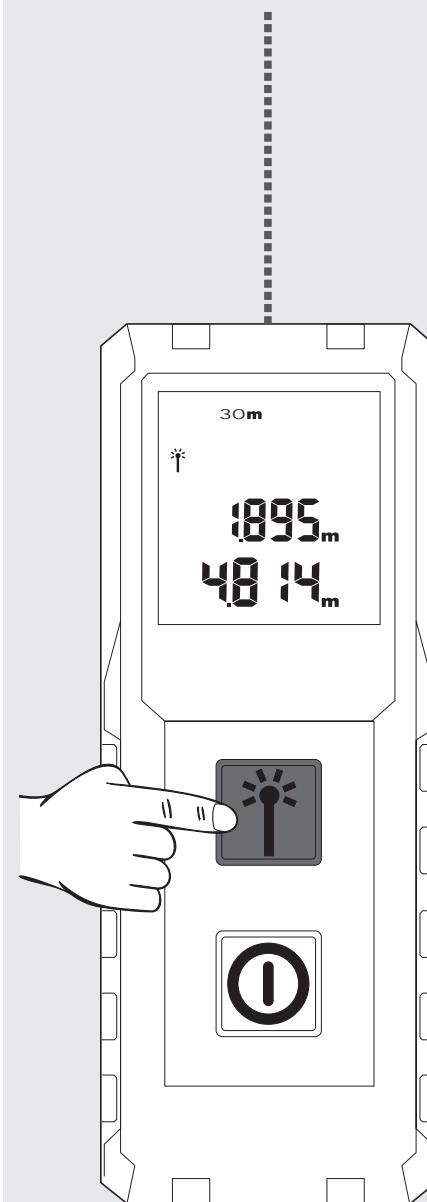
Снова нажмите кнопку измерения, чтобы начать следующее измерение. Предыдущее измерение переместится в поле памяти.
