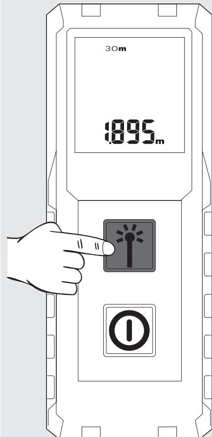
Πιέστε πάλι το πλήκτρο μέτρησης, για να ξεκινήσετε μια νέα μέτρηση. Η προηγούμενη μέτρηση μετατοπίζεται στο πεδίο απομνημόνευσης από πάνω.
