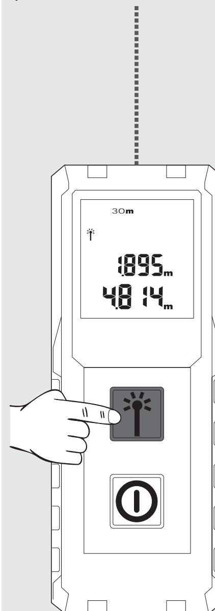
Pritisnute nanovo mjernu tipku kako bi mogli startati sljedeće mjerjenje. Prijasnjje mjerjenje će biti pomjereno na polje memoracije iznad nje.
