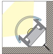
Skruva fast fästet mot underlaget. Skjut/Klicka ned profilen i fästet.
