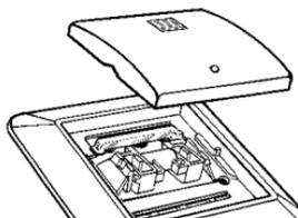
Montering av lysenhet på brytere med skrutilkobling.
