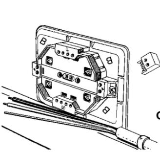
**N** Kabeln kappes i kant med bakplaten på motsatt side av innføringen.
