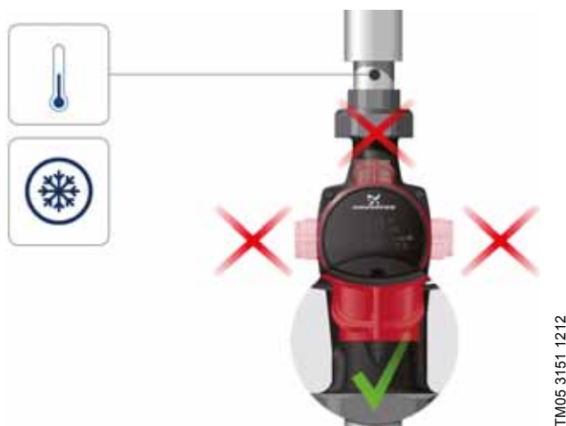
Fig. 4 Styrenhetens position, luftkonditionerings- och kallvattensystem.
