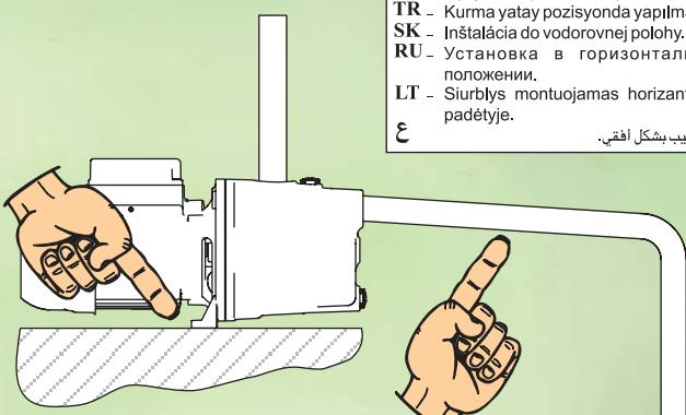
**IT** - Pendenza positiva del tubo d'aspirazione verso l'elettropompa.
