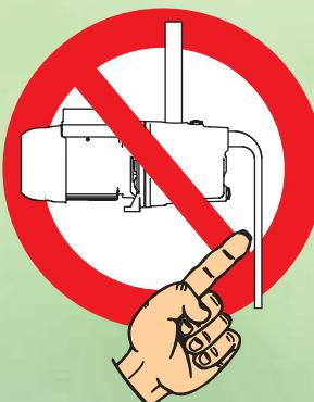
**IT** - Diametro tubo aspirante  $\geq$  diametro bocca dell'elettropompa.
