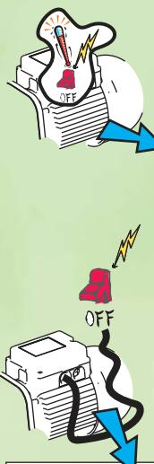
**IT** - I motori trifase devono essere protetti con interruttore automatico (es.magnetotermico) tarato ai dati di targa dell'elettropompa.
