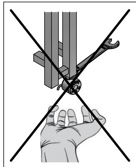
**- Skulle det visa sig att driftsindikatorn hamnar inåt vägg efter åtdragning, justera då alltid bakåt med avsedd nyckel. Packningen är avsedd för att klara justering bakåt utan läckage.**
