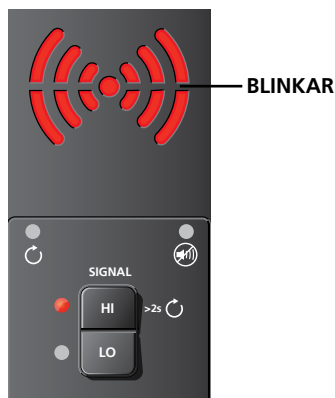
Bild 3.1c: Sändningsskärmen visar signal i HÖGT läge
