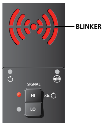
Figur 3.1c: Senderskærm med signal i HØJ tilstand
