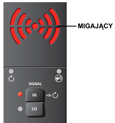
Rysunek 3.1c: Ekran nadajnika pokazuje sygnał w trybie WYSOKI
