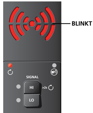
Abbildung 4.12b: Anzeige des Senders im Signalmodus Schleife
