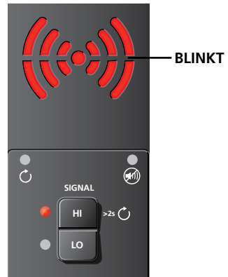
Abbildung 3.1c: Anzeige des Senders im Signalmodus Stark (HIGH/HI)
