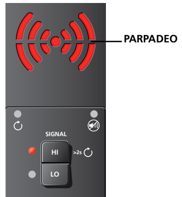
Figura 3.1c: Pantalla del transmisor que muestra la señal en el modo HIGH (ALTO)
