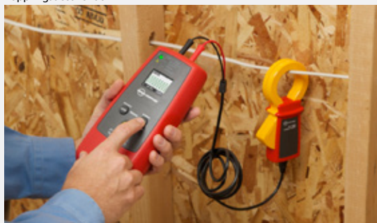
Inducera signalen med signaltången om det inte finns någon naken ledare.
