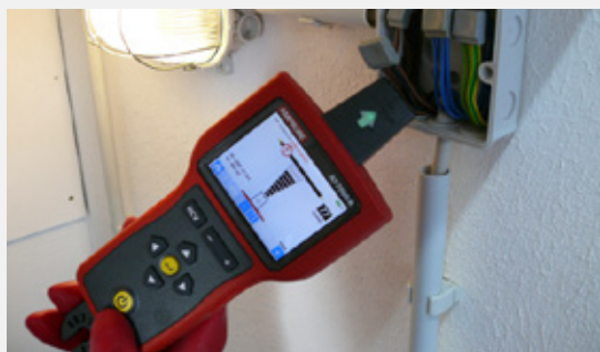
Hitta spänningsatta och spänningslösa kablar genom att ta bort kopplingsdosans lock.
