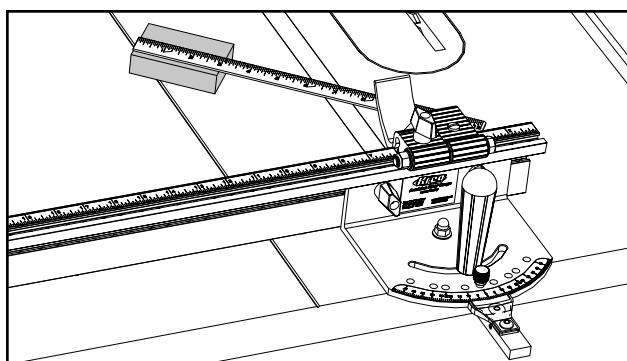
Realice un corte de prueba para confirmar la longitud de 3 pulg (7,62 cm). Ajuste la posición del cursor según sea necesario y realice otro corte de prueba.
