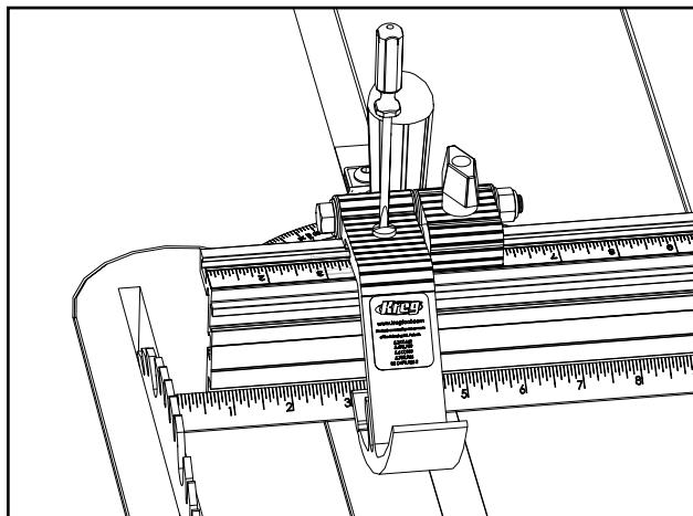
Utilisez une règle en acier normale (avec la marque du zéro à son extrémité) pour placer le bras de la butée à 7,62 cm de la lame. Les dents de la lame doivent effleurer l'extrémité de la règle. (N'utilisez pas le curseur et le ruban à mesurer pour positionner le bras de butée.) Vissez le bouton en T de la butée.
