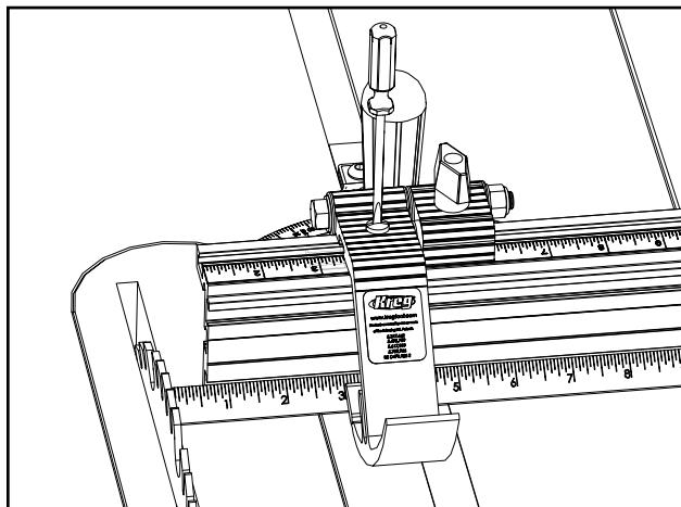
Use una regla de metal de taller (una con la marca en cero al ras con el extremo) para posicionar el brazo de tope a 3 pulg (7,62 cm) de la hoja. Permita que los dientes de la hoja rocen el extremo de la regla. (No use el cursor ni la cinta métrica para posicionar el brazo de tope). Apriete la perilla en T del tope.
