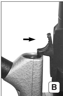
**(D)** **Ein- und Ausschalten (A+B):** **A: EIN** - Schalterschieber nach unten schieben. **B: AUS** - Auf oberes Ende des Schalterschiebers drücken. **Um unbeabsichtigtes Anlaufen zu vermeiden:** Maschine stets ausschalten, wenn der Stecker aus der Steckdose gezogen wird oder wenn eine Stromunterbrechung eingetreten ist.
